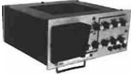
**MK 001.** Du continu à 2 MHz. Atténuateur étalonné, compensé de 5 mV à 10 V. BT de 10 Hz à 200 kHz.
