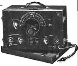
Atténuateur à 4 positions avec en plus un vernier. Valve = 80 - Oscillatrice 6J5. Modulatrice 76. Alimentation secteur incorporée de 105 à 130 volts. Dimension : 380x240x140 mm. Appareil en excellent état et étalonné. LIVRE AVEC NOTICE.
