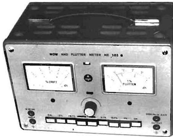
Un générateur interne délivre un signal sinusoïdal de référence à cette fréquence avec une stabilité de  $10^{-3}$  soit un pour mille. Ce générateur sera utilisé pour
