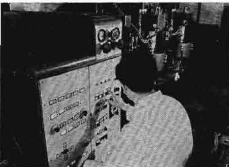
Photos n° 1 : (a) Voici une machine d'oxycoupage à commande numérique ; (b) Son fonctionnement peut être commandé par une bande perforée créée par ordinateur.
