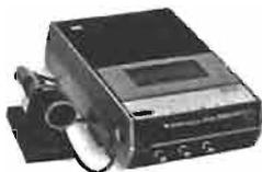
**Magnétophone à cassette stéréo Sony TC124CS.** — Alim. pile ou secteur - 4 pistes - vitesse : 4,75 cm/s. Réponse en fréquence : 50 à 10 000 Hz. Rapport signal/bruit : 46 dB. Puissance : 2 x 1 W. Entrées : micro : 0,25 mV/400  $\Omega$ . Aux. : 0,078 V/100 k $\Omega$ . Sorties : H.P. 0,775 V/8  $\Omega$ . Casque : 24,5 mV/8  $\Omega$ . Dimensions : 170 x 68 x 249 mm. Poids : 2,2 kg.
