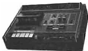
**Platine de magnétophone à cassette Sony TC165.** — Alimentation secteur : 110/220 V - 50/60 Hz. Magnéto-stéréo 4 pistes - vitesse : 4,75 cm/s. Réponse en fréquence : 30 à 14 000 Hz. Rapport signal/bruit : 49 dB. Dispositif Reverse - entrées : 2 microphones basse impédance - sensibilité : 0,19 mV. Auxiliaire : 62 mV/100 k $\Omega$ . Sortie : ligne : 0,775 V/3,9 k $\Omega$ . Casque : 30,8 M/8  $\Omega$ . Dimensions : 400 x 127 = 276 mm. Poids : 7 kg.
