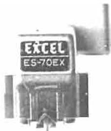
**La cellule phonocaptrice ES70 Excel Sound :** Caractéristiques : Réponse en fréquences : 10 Hz à 35 000 Hz. Tension délivrée : 3 mV. Séparation des canaux : 30 dB à 1 000 Hz. Compliance :  $20 \times 10^{-6}$  cm/dyne vertical et horizontal. Force de tracking : 0,7 à 2 g. Diamant elliptique. Poids : 5 g. Style de remplacement : S70EX.
