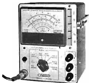
Fig. 5. — Exemple de VE contenant parfaitement à la mesure (type 442 CENTRAD)
