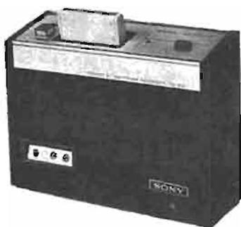
**Lecteur enregistreur de cartouches TC8W.** — Alim. : 110/220 V - 50/60 Hz. 8 pistes - vitesse : 9,5 cm/s. Réponse en fréquence : 45 à 13 000 Hz. Rapport signal/bruit : 52 dB. Entrées : micro : 0,14 mV/600  $\Omega$ . Aux. : 43,5 mV/1,2 M $\Omega$ . Sortie : ligne : 0,775 V/10 k $\Omega$ . Casque : 17 mV/8  $\Omega$ . Dimensions : 329 x 263 x 172 mm. Poids : 6,7 kg.
