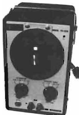
**Le générateur BF TE22D**. — **Gamme de fréquence** : Signal sinusoïdal : 20 Hz à 200 kHz
