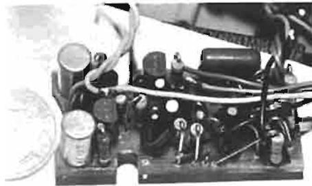
Ampli de servo Kraft RS9S. Les composants sont à l'aise. Les dépôts des fils +, -, e, + st, se soudent sur les conducteurs nus des résistances. Remarquer particulièrement, les fils OV alimentation et moteur, soudés sur le haut de  $R_4$ .
