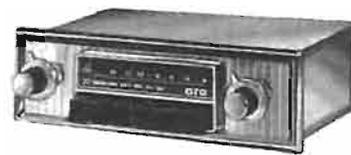
alimentation, 12 V moins à la masse. Indicateur de gamme. Réglage du trimmer. Prise magnétophone ou lecteur de cassette. Prise antenne électrique. Stabilité de fonctionnement : -20 à +60°C. Encombrement 103 x 130 x 52 mm.
