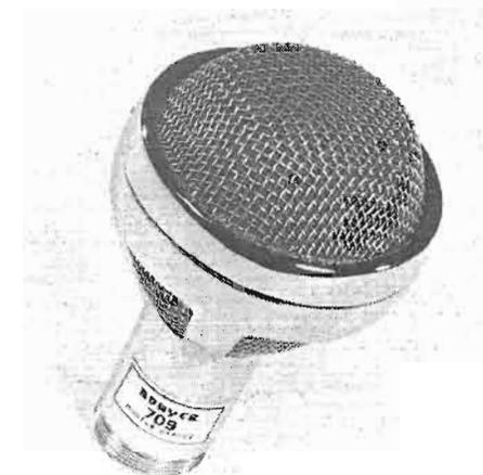
**Le microphone spécial parole 709C.** — Microphone électrodynamique conçu pour la parole — effet anti-larsen —. Bande passante : 200 à 15 000 Hz. Impédance 200  $\Omega$ . Dimensions : longueur 75 mm, diamètre 50 mm, poids 125 g. Transformateur conseillé : GZ22 (200  $\Omega$  haute impédance).
