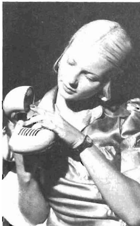
**Le récepteur à transistors RL012 - Snake.** Récepteur GO. Prise écouteur individuel. Alimentation 1 pile de 9 V. Cadran circulaire. Coffret de forme originale, bleu, jaune, ivoire, rouge. Diamètre (fermé) : 154 mm.
