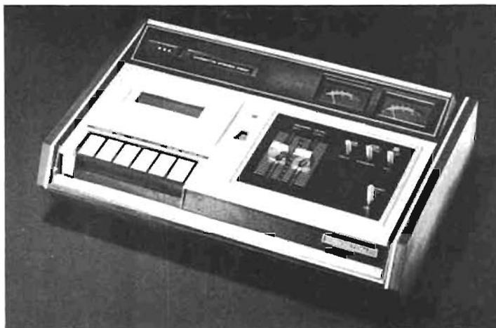
cabestan. Entre la section mécanique et la section électronique, un indicateur lumineux témoigne du défilement de la bande. Sur la droite sont placés les deux potentiomètres réglant le niveau d'enregistrement. Les trois commutateurs servent l'un à la mise sous tension du BSD200, le second à la mise en service du dolby, avec voyant témoin, et le dernier au passage bande normale, bande au dioxyde de chrome.
