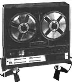
3261 : **MAGNÉTOPHONE STÉRÉO HI-FI** - 3 vitesses : 7,5/9,5/19 cm/sec. - Ampli : 2 x 5 W - 2 têtes magnétiques - Bobines 18 cm - Contrôle de l'enregistrement par 2 vu-mètres - Playback - Prises : micro, radio, PU, HPS, casque stéréo - 2 HP incorporés - Présentation : ébénisterie palissandre, couvercle plexi fumé - Fourni avec bande magnétique, télécommande, micro, cordon de raccordement - Dimensions : 368 x 419 x 165 mm. **1 600 F**
