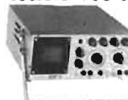
Entièrement transistorisé avec transistors à effets de champ et circuits intégrés. Tube cathodique rond de 7 cm. Bande passante de 0 à 5 MHz (± 3 dB). Alternateur vertical compensé 12 positions. Impédance entrée : 1 MΩ (10 avec sonde), etc. Alimentation secteur 110/220 (100 x 230 x 240). Poids : 3,5 kg.
