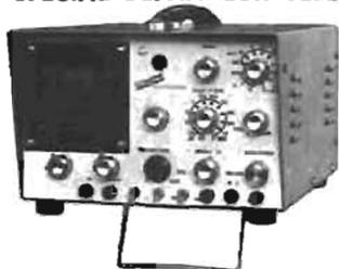
● Tout transistors circuit Intégré ● Avec synchro TV ligne et image. ● BP : 8 MHz. Sensibilité 5 mV division ● Atténuateur étaloné ● BT déclenchée de 5 secondes à 1 microseconde ● Tube rectangulaire 5x7 ● Poids 5 kg. PRIX EN KIT ..... T.T.C. 1 700,00
