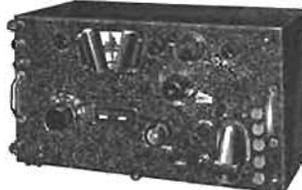
Couvre de 1 500 Kc/s à 18 Mc/s en 6 gammes. 10 tubes : 1° HF 6K7 ; 2° HF 6K7. Oscillatrice 6C5. Détectrice 6L7 - 1° MF 6K7 - 2° MF 6K7. Détectrice AVC BF 6R7 - BFO 6C5 - BF 6F6 valve 5W4GT. BFO. Alimentation secteur 110-220 V incorporée LIVRE EN PARFAIT ETAT DE MARCHÉ ET DE PRÉSENTATION. AVEC NOTICE EN FRANÇAIS. PRIX T.T.C. .... 500 F + port 25 F Le même A L'ETAT DE NEUF. PRIX 600 F + port 25 F
