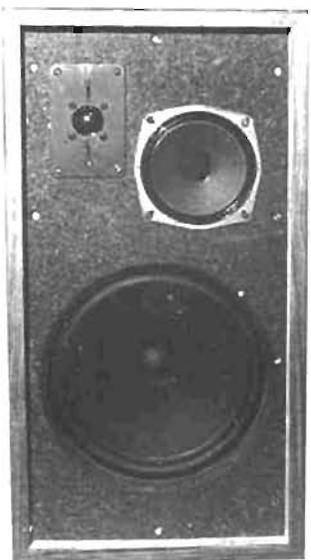
**30 Omni** - Enceinte 4 voies omnidirectionnelle - Même système de reproduction basses que 50 Omni équivaut à 40 cm de membrane - P. 30 W - B. P. 25 à 20 000 Hz - Composition basses 1 HP 245 mm, 1 HP 210 mm - Médium 1 HP 13 cm - Aiguës et Haut médiums 2 HP elliptiques + 1 HP à dôme hémisphérique - Dim. : 56 x 30 x 25.
