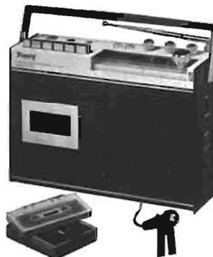
OC - PO - GO - FM - Secteur, piles. Sortie 1 W. 1 GT. 10 diodes. Ferrite PO-GO. Ant. télesc. 0,75 m OC-FM. Partie cassette défil. 4,75, 2 pistes. Rép. 150/6 000 Hz. Micro dyn. Dim. : 322x 218x99 mm. Vu-mètre pour contrôles enreg. ou charge batterie.
