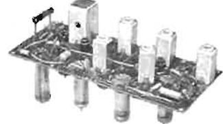
Avec sortie son, et ses 8 lampes (trois EF184 - EB91 - ECL86 - EBF89 - EF80 - EL183), dimensions 255 x 112 mm. Schéma fourni.
