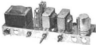
Constitué d'une double triode ECC83 et de 2 triodes-pentodes ECL86, alim. 110-220 V, contrôle GRAVES et AIGUES séparé, balance stéréo, niveau d'entrée prévu pour cellule stéréo céramique (ou cristal), encombr. 305 x 90 x 110 mm, le châssis très étroit (90) peut contenir dans l'épaisseur de n'importe quelle valise ou ébénisterie. Livré en pièces détachées pour montage par soi-même, avec 2 haut-parleurs 21 cm et schéma de montage. Prix T.T.C. .... **149,00** + port et emballage 15,00
