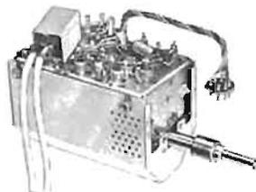
Dotés d'un accord d'appoint (fin) entrée antenne 75 Ω, sortie FI 50 Ω, alimentation 12 volts, avec ses 11 barrettes.
