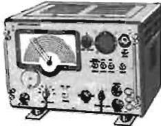
Superhétérodyne à double changement de fréquence, 1 400 kHz et 80 kHz.
