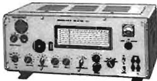
Superhétérodyne à double changement de fréquence 1 600 kHz et 80 kHz.
