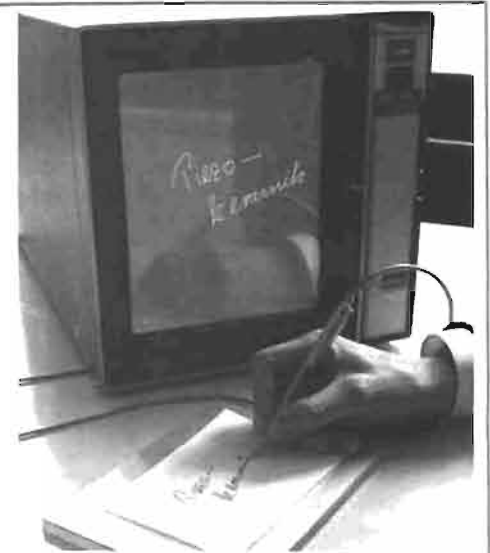
Photo 6. — La plaquette piézo-électrique: des données manuscrites pour l'ordinateur. (Cliché SIEMENS)
