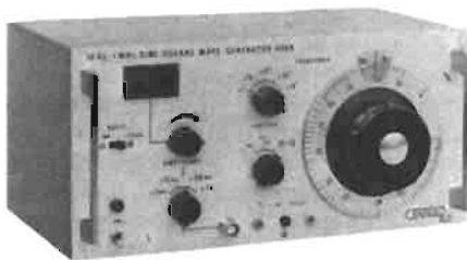
Générateur BF 466K de Centrad 10 Hz - 101Hz. Kit d'assemblage pour affichage par diodes électroluminescentes de IEC Souriau.
