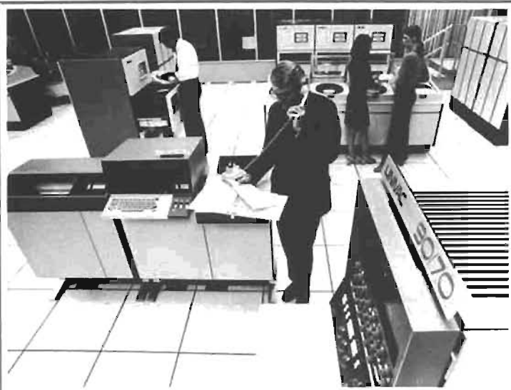
Photographie n° 2 — Voici l'UNIVAC 90/70; sa mémoire centrale et ses périphériques forment le « hardware ». Il faut pouvoir utiliser ces éléments pour un usage productif: les moyens (programmes essentiellement) qui permettent d'utiliser un ordinateur, de communiquer avec lui, sont fournis par le « software ».
