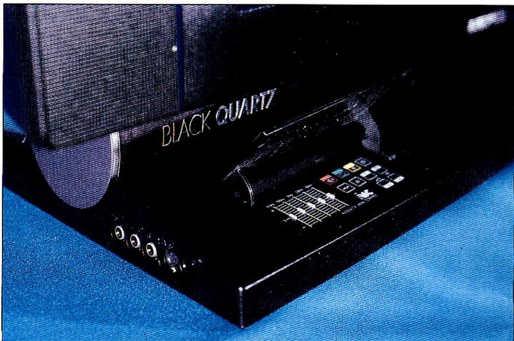
*Luxeux Thomson : le piètement recèle, sous une trappe, un égaliseur audio à cinq bandes. Sur le côté, des prises d'entrées AV : soit en RCA pour la vidéocomposite et l'audio, soit en mini-DIN 4 broches pour la vidéo Y/C.*
