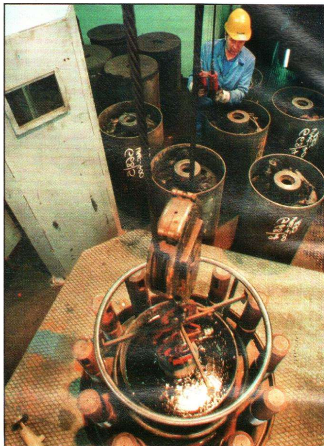
La fabrication du dioxyde de chrome, c'est de la chimie ! Sans chimie, pas de bandes audio ou vidéo, pas plus que de bandes et disques ou disquettes pour informatique. Le dioxyde de chrome, séché après réaction chimique, l'est grâce à de tels filtres.
