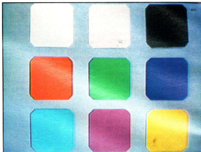
La mire de couleurs, visée par un caméscope, et visualisée sur un écran TV (sans avoir été enregistrée). Remarquez le net retrait du rouge, la déformation.
