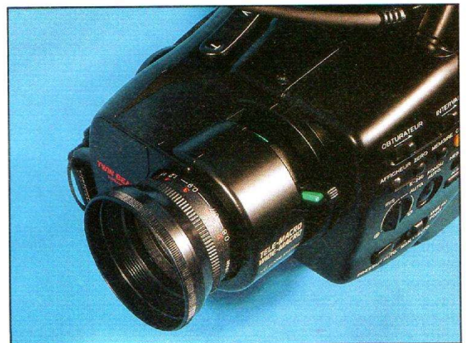
Rare : une mise au point automatique par double rayon infrarouge, efficace en toutes circonstances ; plus rare encore : une double position « macro » exploitable tant en téléobjectif qu'en grand angle (Hitachi VM-3300).
