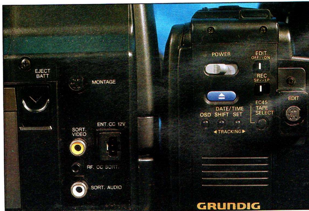
« Montage » ou « Edit », par prise cinq broches sur deux châssis d'origine Panasonic, chez qui on trouve aussi de belles tables pour cette opération. L'idée fait son chemin et a le mérite d'exploiter une connectique normalisée.
