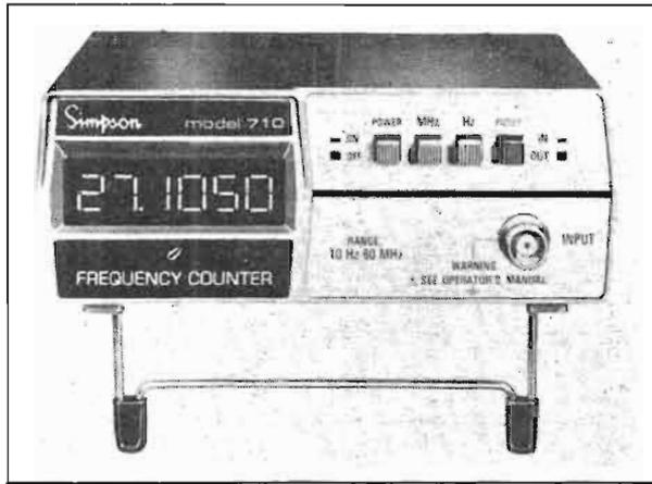
Simpson, distribué par Elexo, présente un nouveau fréquence-mètre, modèle 710. Le modèle 710 mesure les fréquences de 10 Hz à 60 MHz avec 6 chiffres, en deux gammes : 1 MHz avec une résolution de 1 Hz et 60 MHz, avec une résolution de 100 Hz.
