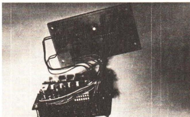
Photo O: Les circuits additionneurs de fréquences et affichages tels qu'ils se présentent pour les tests avant le montage final.
