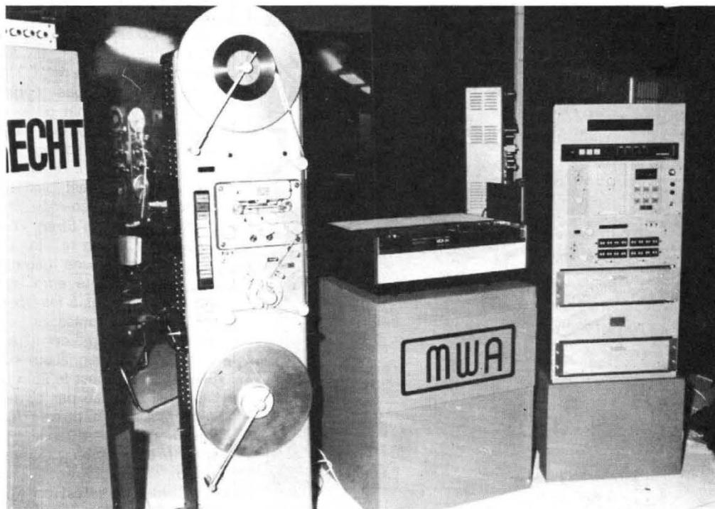
Photo 2. - Magnéscope avec son synchronisé sur film magnétique séparé.
