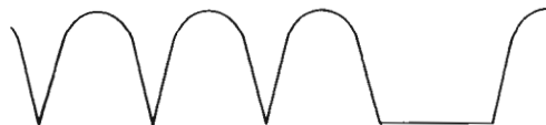
Fig. 2. - L'intensité de maintien du thyristor commandé est assurée, en dehors des coupures complètes, par un filtrage partiel.
