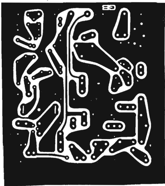
Fig. 3. - Le circuit imprimé, vu côté cuivre.
