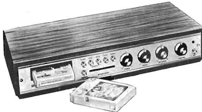
habillé d'une ébénisterie. Sur la partie gauche de la face avant se trouve l'orifice d'introduction de la cartouche. Une série de boutons poussoir commute les différentes entrées. Puis, du-centre à la partie droite, quatre boutons couplés à des potentiomètres commandent respectivement les correcteurs de tonalité aigus et graves, la balance, et le volume. A l'extrême droite la touche arrêt-marche est surmontée d'un voyant lumineux.
