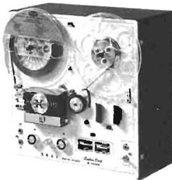
Correction d'enregistrement/reproduction : d'après NAB. Consommation : 50 W. Tension d'utilisation : 100-240 V/50-60 Hz. Dimensions, coffret noyer : 34x34x23 cm. Poids : 14 kg.
