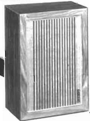
Puissance nominale: 6 W - Puissance de crête: 8 W - Impédance standard: 4 à 8 ohms - Raccordement: cordon 1,50 m avec fiche DIN - Coffret bois: noyer d'Amérique - Bande passante: 60 — 15000 Hz - Poids: 1,7 kg - Dim. 235x129x165 mm.
