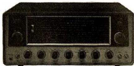
Récepteur de trafic JR 60 - (décrit dans le N° 1098 du Haut-Parleur) Superhétérodyne 14 tubes - Etage spécial mélangeur oscillateur pour bande 2 mètres - Fonctionne également de 540 kcs à 30 mcs sans trou - c'est-à-dire de 550 mètres à 10 mètres - Modes de réception AM/CW/SSB/FM - Band-Spread pour Bandes Amateurs. F. 1350
