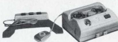
**PHILIPS EL 3581** Alimentation 110/220 volts - Vitesse 4,75 - Bobines 10 cm - 2 pistes par retournement (2 x 20 minutes) - Compte-tours - Marche AVANT et ARRIERE rapide - Prise pour écoute sur casque - Ampli : ECC83 - EL95 - Dimensions : 250 x 195 x 100 mm - 3,6 kg - Fourni avec combiné MICRO/H.-P. et pédale de commande, à distance ..... **250,00**
