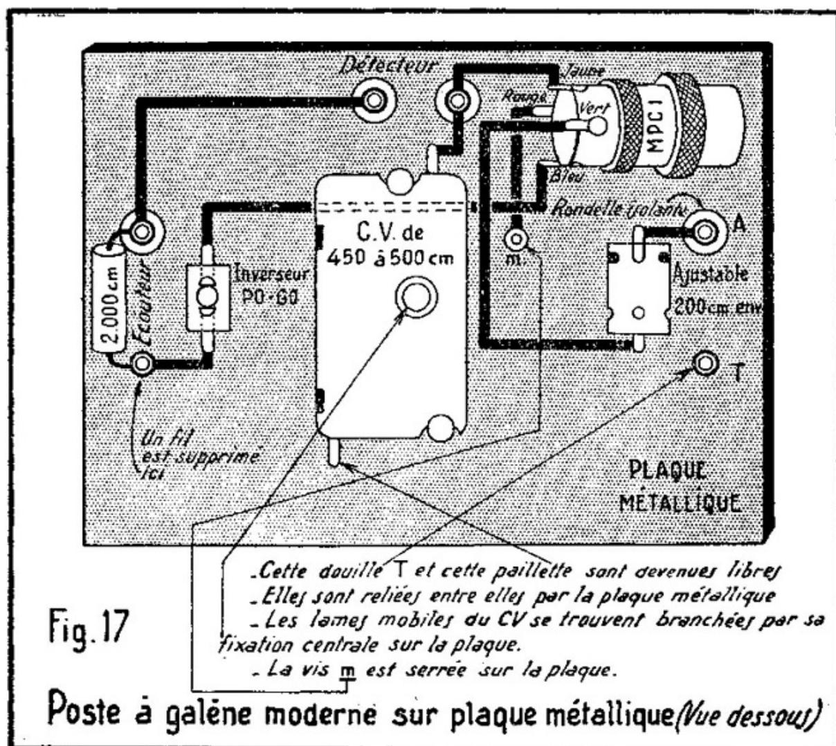
l'écouteur, du condensateur, du variable, du bloc d'accord bobiné et de l'inverseur PO-GO se trouvaient tous reliés à la douille « Terre ». Il n'y a donc pas à les isoler entre eux. Au contraire, cette plaquette métallique fera une liaison toute trouvée qui nous économisera du fil et en constituera un de plus grandes dimensions encore. Mais alors, attention aux autres paillettes ou bornes qui, elles, ne vont pas à la terre ! Elles doivent en être sérieusement isolées.
