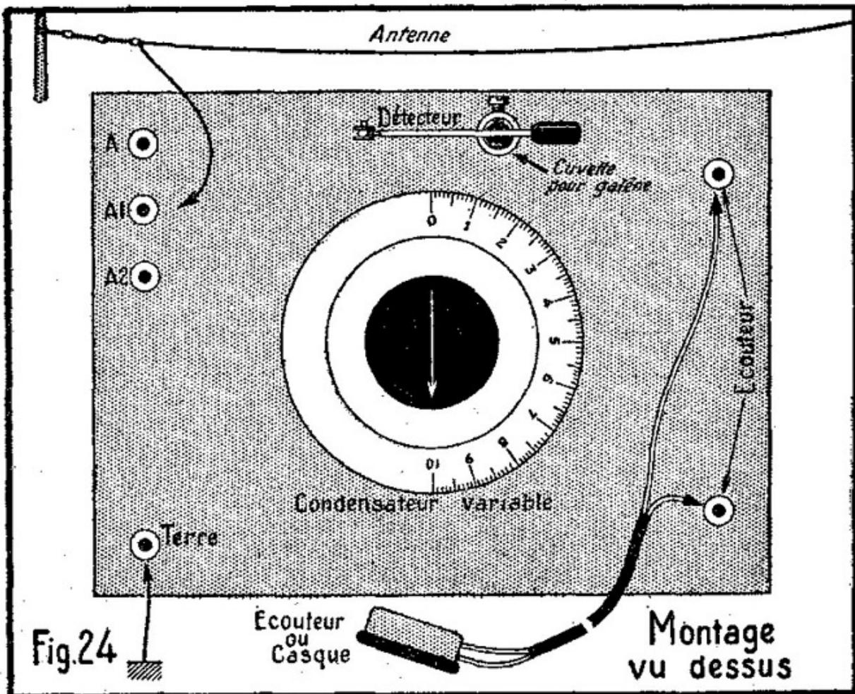
La *figure 21* schématise un autre bobinage de la même marque où des prises peuvent être faites en *A*, *A'* ou *A2*, ce qui correspond respectivement à l'entrée *e*, la première prise intermédiaire *i* ou la seconde *i'*. La vue du bobinage et son encombrement sont donnés à la *figure 22*. Quant au montage possible à réaliser, il est fourni : vu dessous à la *figure 23* et vue dessus à la *figure 24*.
