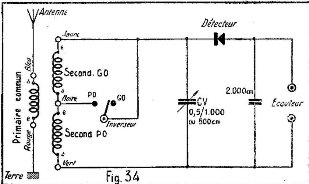
Signalons que le montage est dit « en Tesla », c'est-à-dire avec deux enroulements distincts : l'un Antenne-Terre ou Primaire et l'autre appelé Secondaire, et accordé par le CV, est un de ceux qui permettent avec plus de facilité, et dans certains cas, la séparation assez nette d'émissions de longueurs d'ondes voisines.
