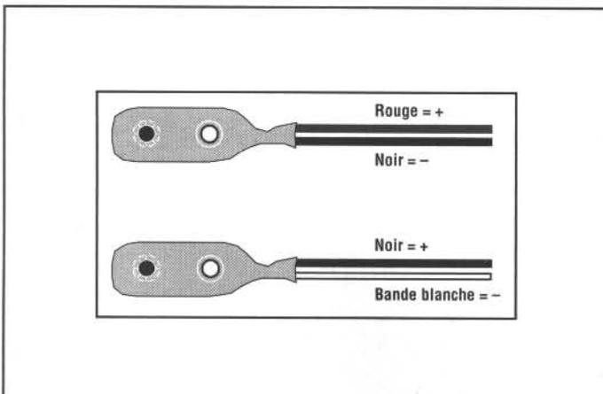
L'écoute est possible avec un haut-parleur de 8 ohms connecté comme cela est représenté sur le schéma d'implantation.
