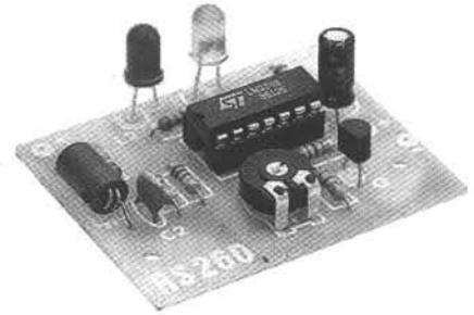
**P**our l'alimenter, il faut une pile de 9 Volts. Sa consommation est de 20 mA environ. Il faut appliquer au point A une antenne télescopique ou
