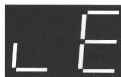
UNE TENSION TROP ÉLEVÉE ARRIVE À LA BATTERIE À CAUSE D'UNE ANOMALIE DANS LE RÉGULATEUR DE RECHARGE
