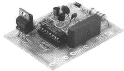
À chaque fois que l'on effleure une petite plaque métallique appropriée, le dispositif entre en fonction comme un interrupteur normal ; en touchant la petite plaque, l'ampoule appliquée comme charge s'allume, en la touchant à nouveau, l'ampoule s'éteint.
