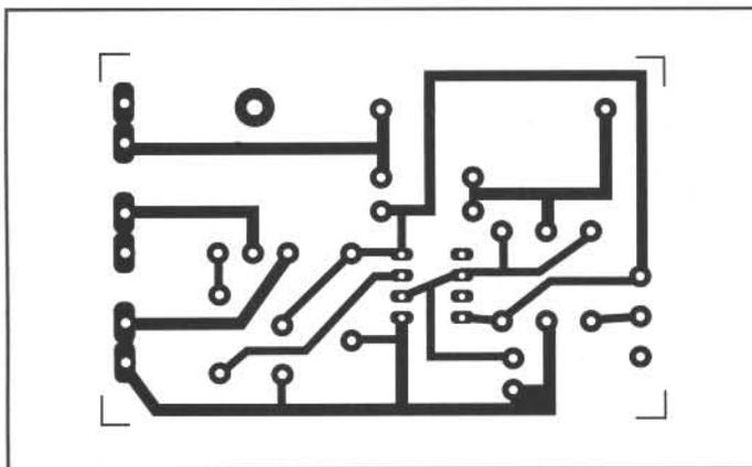
La lampe connectée au dispositif (230 Volts 350 Watts max) s'allume en appuyant sur un bouton et restera dans cet état pour un temps déterminé par le réglage du potentiomètre P1.
