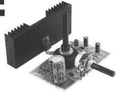
Elle est particulièrement appropriée pour alimenter l'ensemble des petits appareils de reproduction sonore ou petits téléviseurs qui fonctionnent normalement à piles, parce que pas moins de 5 tensions de sortie sélectionnables avec un commutateur adéquat à 6 positions sont prévues :
