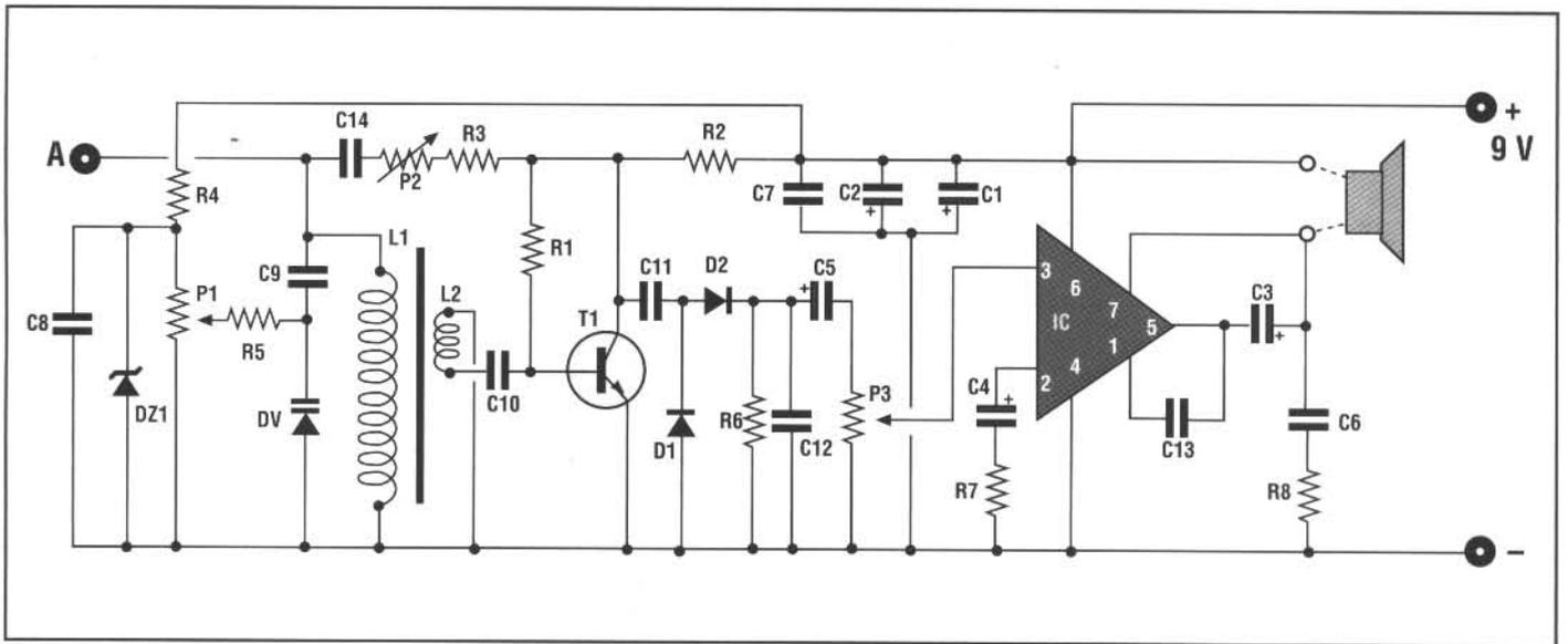
Il est équipé d'un potentiomètre pour le contrôle de la réaction et d'un potentiomètre supplémentaire sert à
