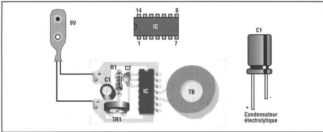
raître. Le signal aura une fréquence d'environ 17 KHz. Tourner encore un peu le trimmer pour arriver à 21 KHz.
