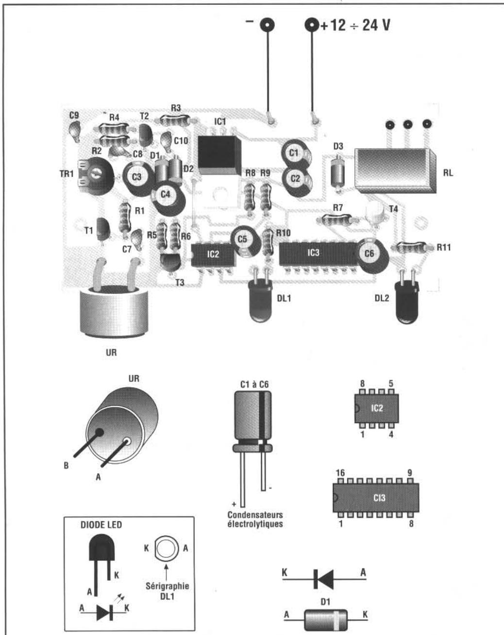
Quand le transducteur UR est de nouveau envahi par des ultrasons, le relais se désexcite, fonctionnant ainsi comme un véritable interrupteur commandé à distance.
