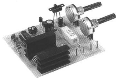
**P**our l'allumage, il faut positionner le sélecteur à glissière DV en position A et le temps qui s'écoule entre l'allumage minimum et maximum de l'ampoule se règle avec le poten-
