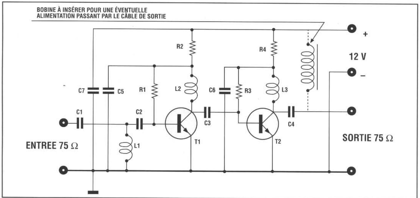
Le gain moyen sur toute la gamme est d'environ 23 db et il faut une tension stabilisée de 12 Volts pour l'alimentation.
