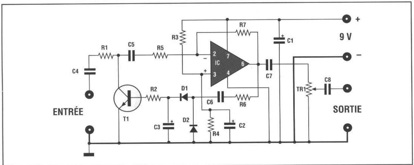
Le trimmer TR1 permet de régler la quantité de signal de sortie. Le tableau suivant permet de voir le nombre d'amplifications en fonction du signal d'entrée :
