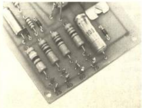
Photo 2. - La commutation des résistances R_1 à R_4 se fera à l'aide des cosses poignards (voir chapitre « Remarques »).
