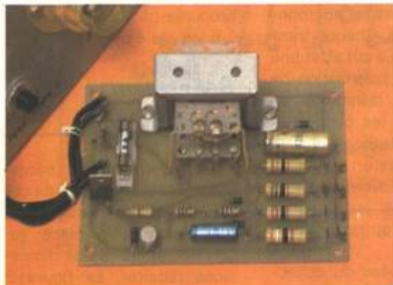
Eclairage de secours.
