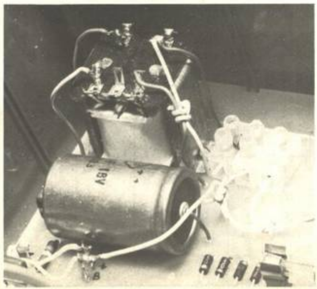
Photo 4. - On utilisera un transformateur de sortie pour un meilleur rendement.
