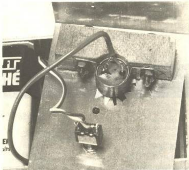
Photo 4. Le transducteur côté récepteur nécessite également un montage un peu spécial : il est maintenu par un collier vissé sur un tasseau lui-même collé sur l'aluminium.
