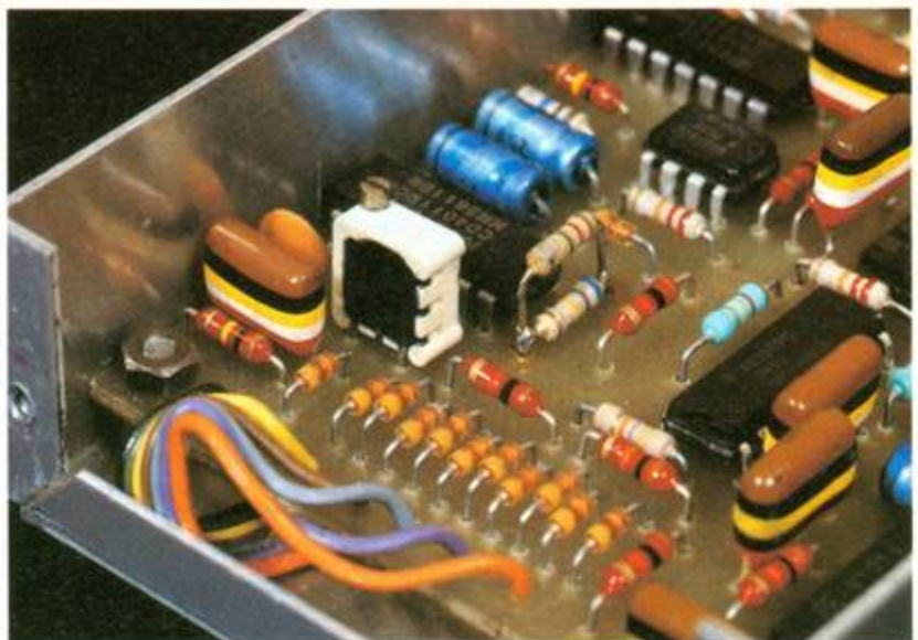
Photos 4. – Un aperçu du jeu de diodes composé de D 1 à D 11 .
