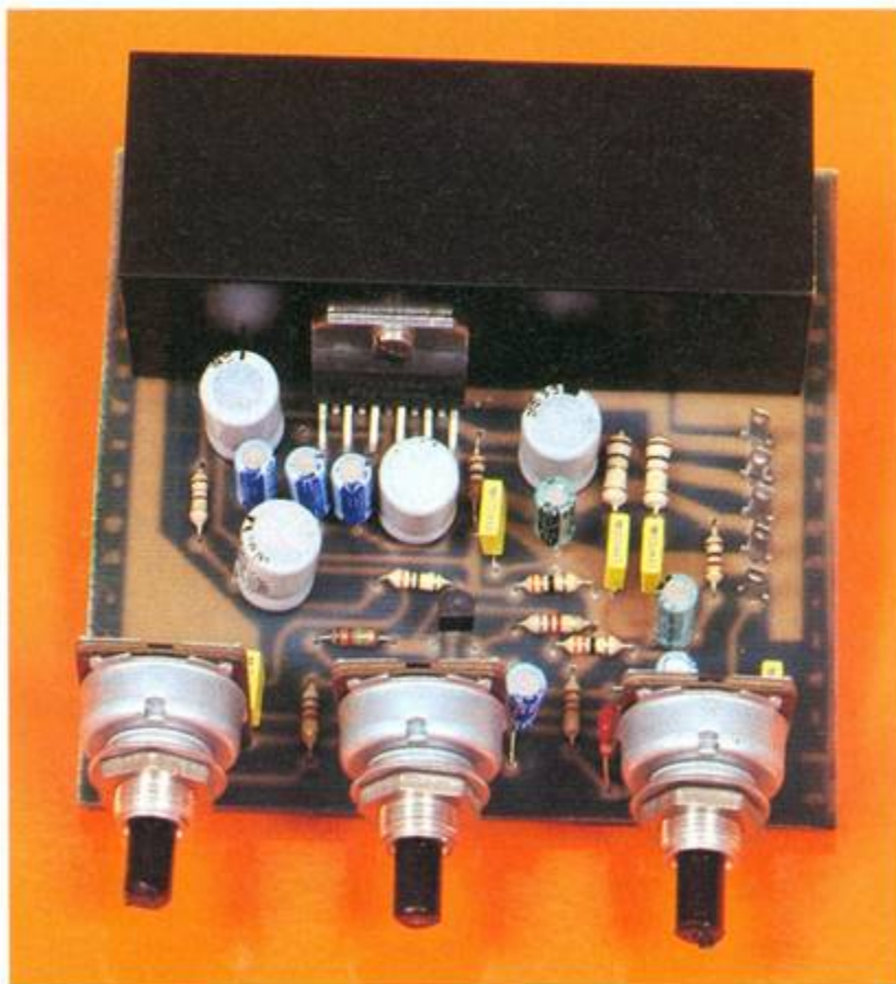
Photo 2. - On montera le TDA 2004 sur un radiateur et les potentiomètres directement sur le C.I.
