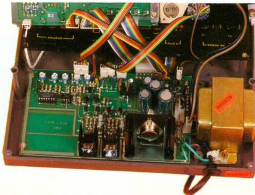
Photo 4. – Gros plan de la section des alimentations.
