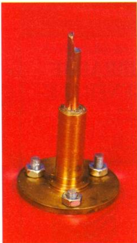
Photo 6. - Détail de l'axe d'entraînement du plateau.
