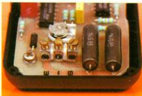
Photo 2. - Vue des résistances chutrices R_1/R_2 situées à proximité des bornes de raccordement.
