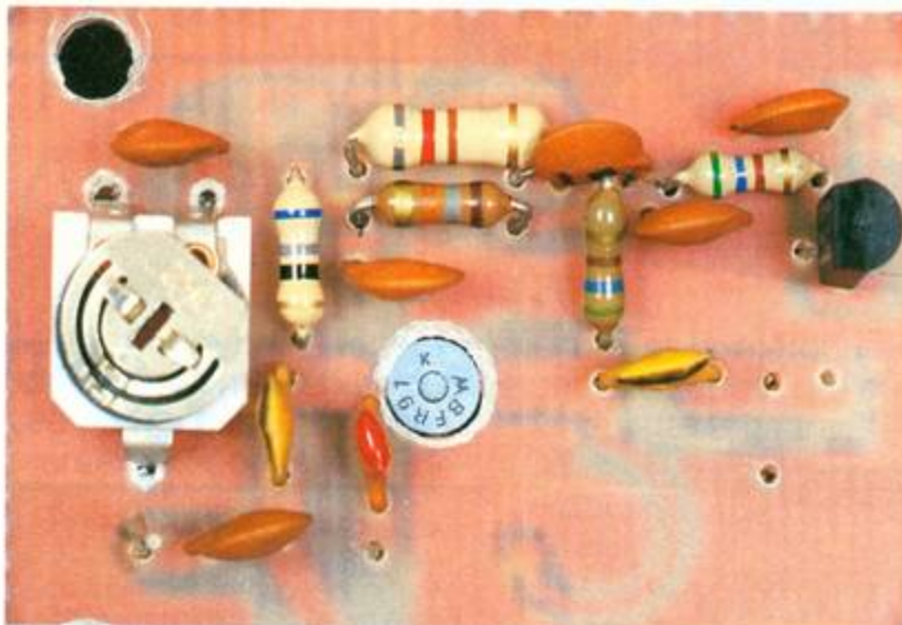
Photo 3. - Vue de l'ajustable R7 et du transistor soudé côté cuivre, se logeant dans un trou de 5 mm.
