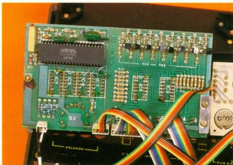
Photo 3. – Le circuit ICL 7107 d'Intersil assurant la conversion A/N et la commande des afficheurs du voltmètre.
