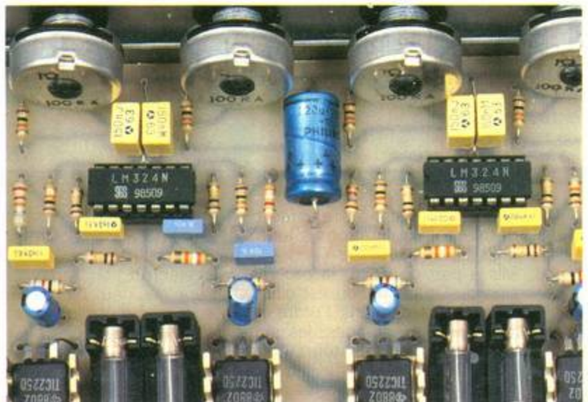
Photo 3. - Le C.I. supporte directement les potentiomètres.
