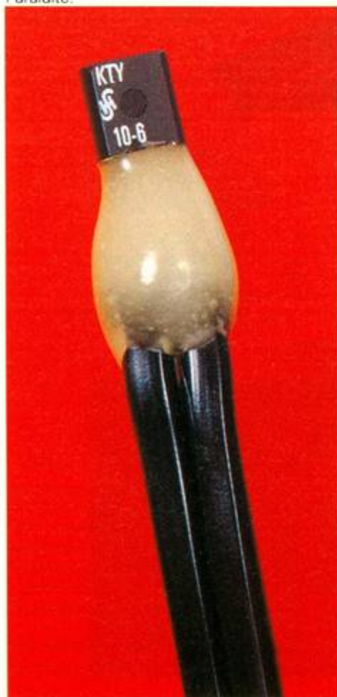
Photo 5. - La sonde étanchéifiée dans de l'araldite.
