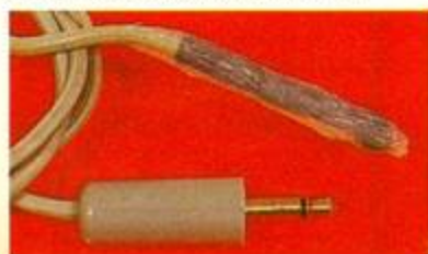
Photo 3. - La sonde, une fois recouverte de gaine thermorétractable, sera enrobée d'un joint silicone.
