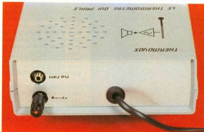
Photo 7. – La face arrière du boîtier accueille les liaisons avec l'extérieur.
