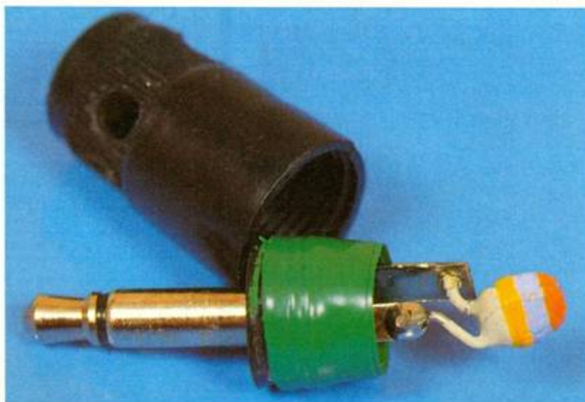
Photo 6. - Le capteur de température s'encapsule dans une fiche Jack mono.
