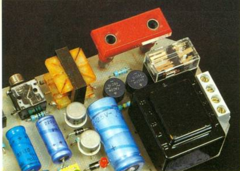
Photo 5. - Le composant rouge est une embase femelle 220 V.
