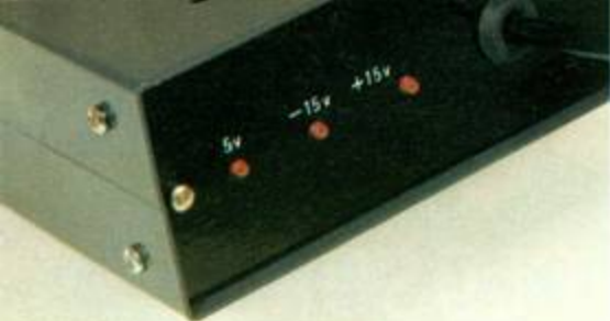
Photo 5. - Les diodes LED en face arrière témoignent de la présence des alimentations.
