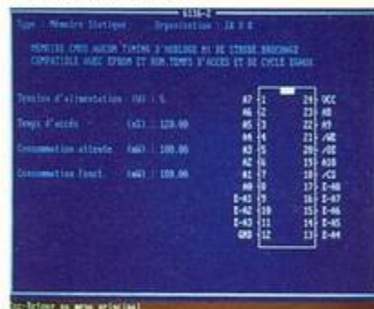
Photo 2. - Fiche caractéristique d'un composant trié ; ici une mémoire CMOS 6116.
