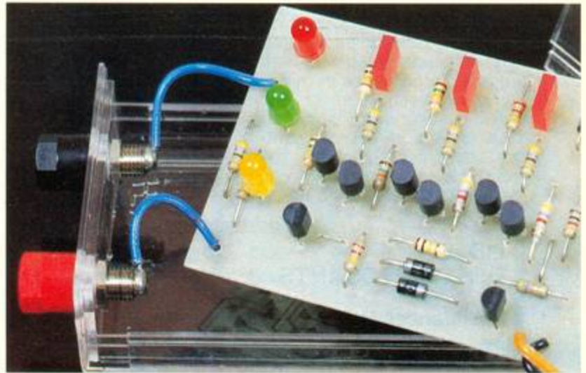
Photo 4. – Liaisons filaires entre les bornes et le circuit imprimé.
