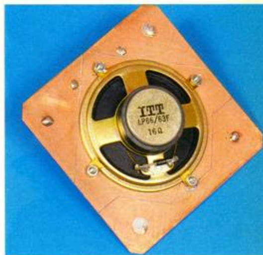
Photo 3. - Vue du haut-parleur immobilisé par des vis sur un morceau d'époxy.
