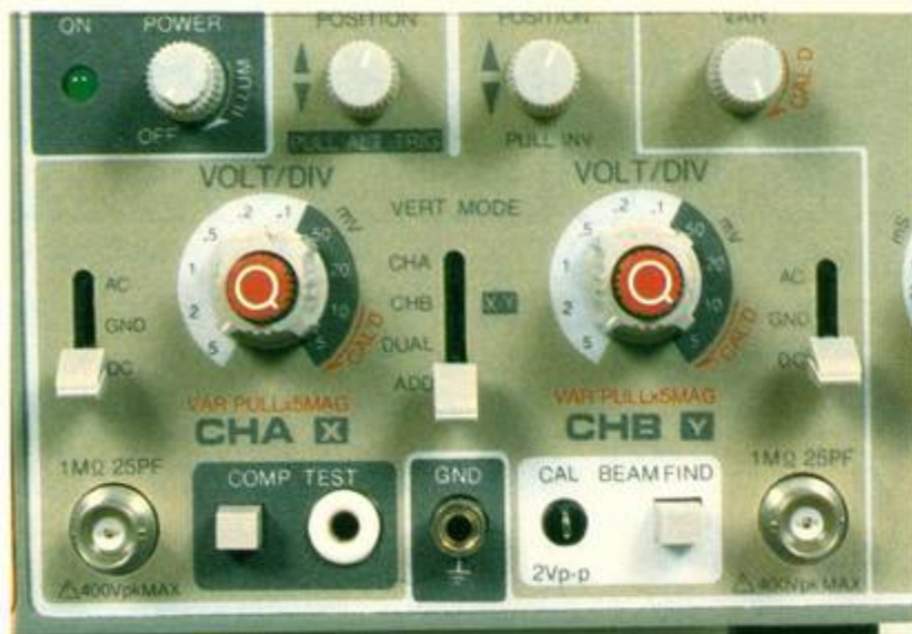
Photo 2. - Gros plan des atténuateurs d'entrée.
