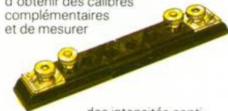
des intensités continues élevées (10 A et 100 A). Une large gamme de pinces et minipinces ampèremétriques de type « transformateur » permettent les mesures d'intensités alternatives élevées,
