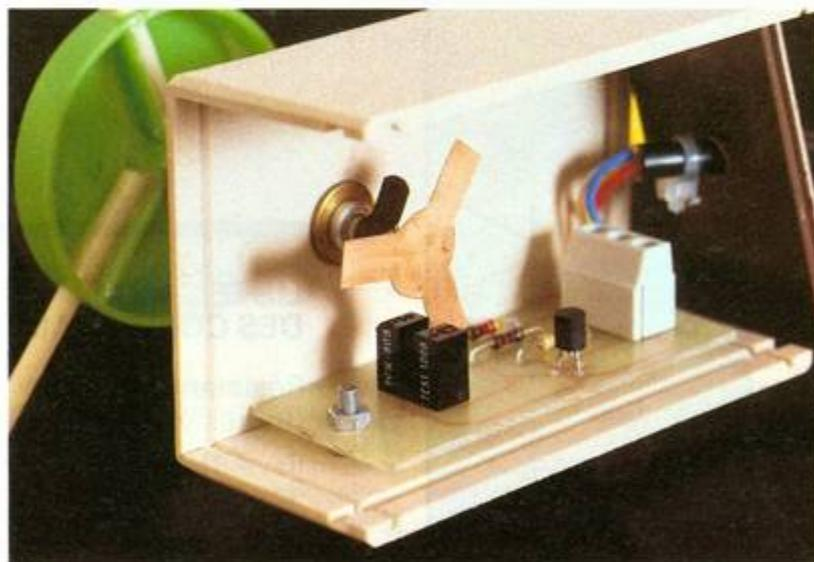
Photo 4. – Le détecteur de vent sera dissocié du boîtier principal. La liaison s'effectuera à l'aide de trois fils.
