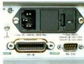
**3.** Les deux interfaces HP-IB et RS-232 sont standard.
