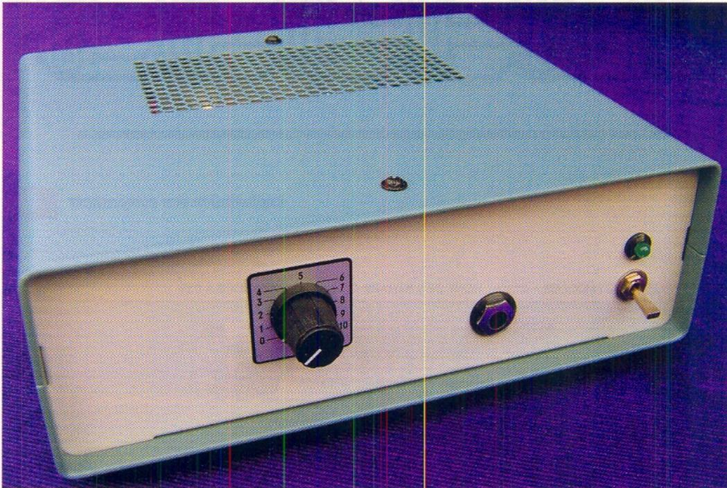
Cet amplificateur développe une puissance nominale de 100 mW sous une grande variété d'impédances. Sa bande passante s'étend de 16 Hz à 60 kHz à -1dB. D'une mise en œuvre simple, il affiche néanmoins d'excellentes performances.
