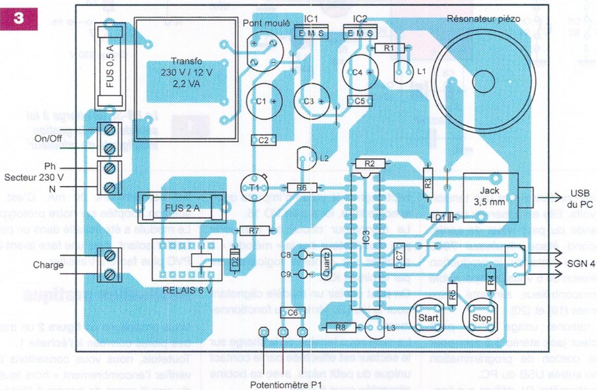
sants est détaillée en **figure 3**. Comme d'habitude, on débute par la mise en place des straps, des résistances et du support de IC3. En règle générale, ne monter les composants actifs qu'en dernier, en veillant à leur parfaite orientation. Le relais utilisé a un courant nominal sur le réseau qui
