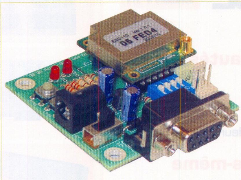
**A**vec l'engouement croissant pour la communication sans fil, POB-Technology adapte la technologie Bluetooth à ses robots. Il est désormais possible de piloter son robot grâce à un téléphone mobile, un PDA ou un ordinateur équipé en Bluetooth.
