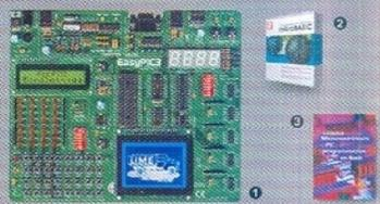
1) **EasyPIC4**: Starter-kit pour développement sur microcontrôleurs PIC™. Programmeur **USB** intégré, supports pour PIC **8, 14, 20, 28** et **40** broches, livré avec PIC16F877, emplacements pour afficheurs LCD 2 x 16 et afficheur LCD graphique 128 x 64 (livrés en option), 32 leds, 32 boutons-poussoirs, 4 afficheurs 7 segments, emplacement pour capteur température DS18S20 (livré en option), connecteur pour clavier PS/2 (non livré), port série, etc. .... **125,00 €**
