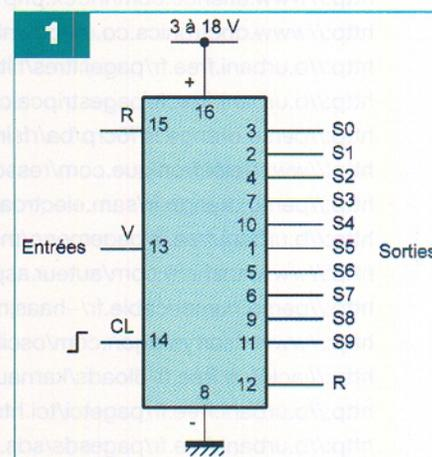
Elle peut être mise à contribution pour attaquer l'entrée « Clock » d'un second compteur placé en aval, ce qui permet d'obtenir une capacité de comptage plus importante : 100 avec deux compteurs, 1000 avec trois, etc. Il est également possible de faire avancer le compteur au rythme de fronts descendants. Dans ce cas, il convient de relier l'entrée « Clock » à un état « haut » permanent et de présenter les fronts descendants sur l'entrée de validation.
