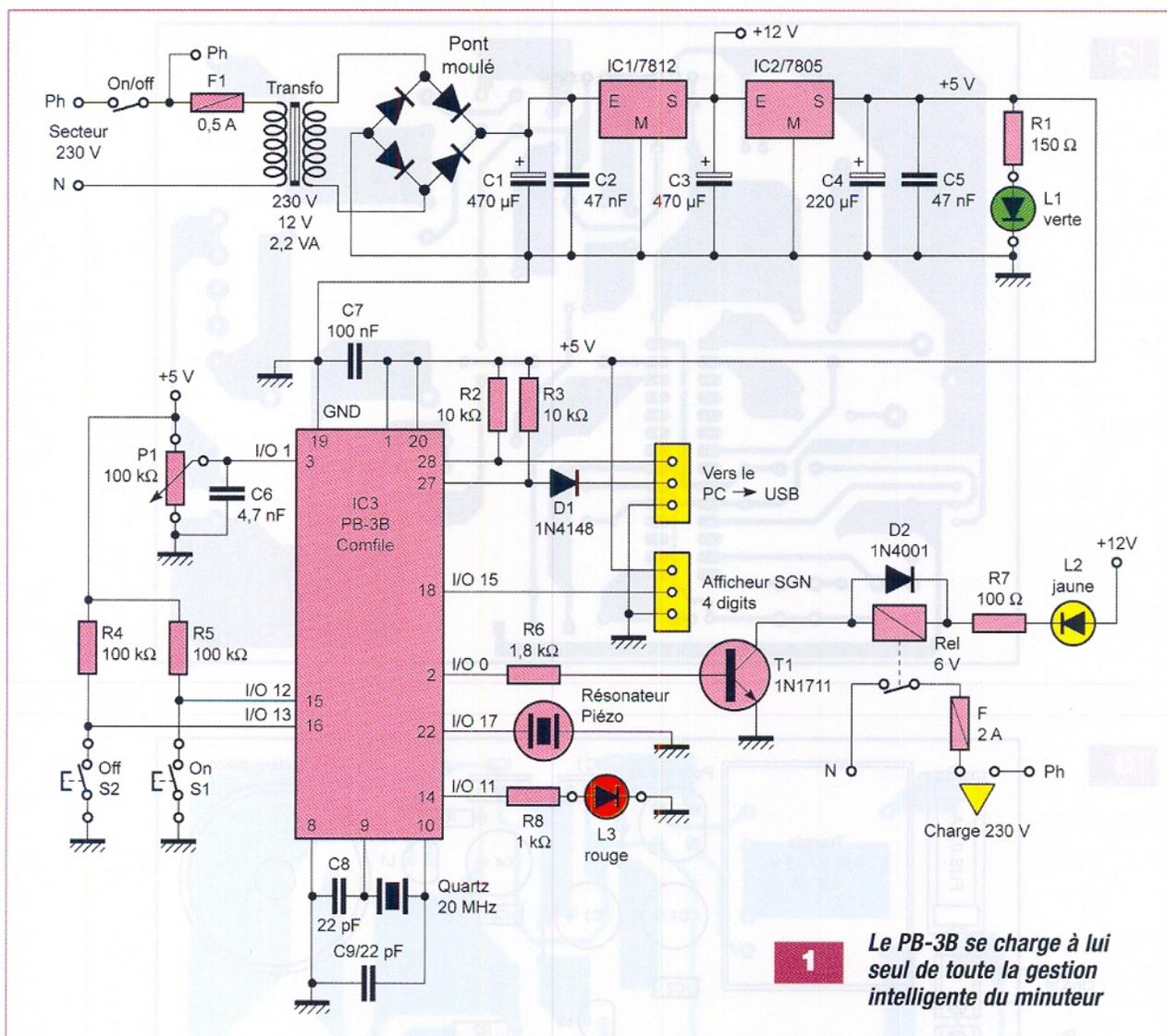
quelques condensateurs une tension de 12 volts. Elle est réservée pour la commande du petit relais de sortie. Un second étage régulateur 7805 assure, bien entendu, la production de la tension de 5 volts indispensable au microcontrôleur, alimenté entre ses bornes (19) et (20).
