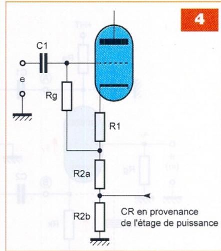
Que se passe-t-il lorsque la tension « e » appliquée à la grille augmente ? La grille swing positivement. Le courant « i » dans le tube augmente, la tension aux bornes de RL descend (c'est le principe même de l'amplification !). Vice-versa, lorsque « e » diminue, la tension RL monte. Nous avons déjà vu tout cela précédemment, mais que se passe-t-il aux bornes de Rk ?
