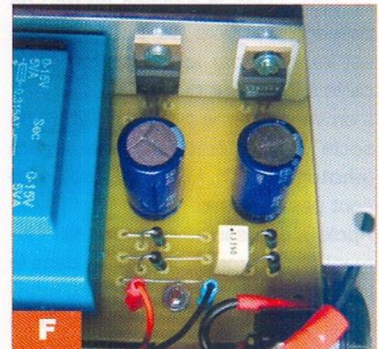
puissance sont vissés directement à ceux-ci sans intercalaire. Le dissipateur des deux régulateurs est constitué d'une plaque en aluminium de dimensions 100 x 30 x 2 mm. Le régulateur positif 7815 est vissé directement, le régulateur négatif 7915 doit être isolé par un intercalaire souple (photo F).
