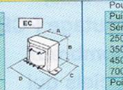
CM-EI DW6, grain orienté, enroulement sandwichés, BP: 20Hz à 20KHz, fixation étrier.
