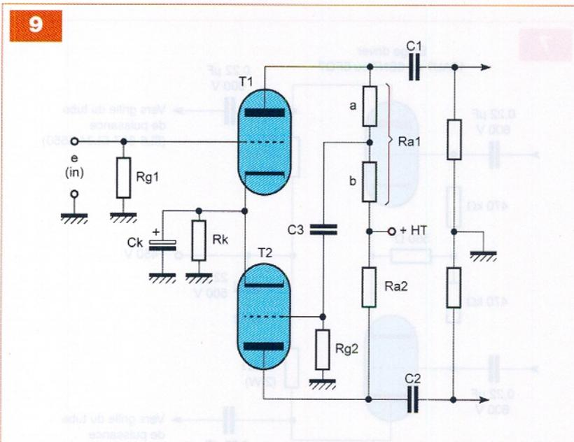
verse du gain de l'étage T1. Pourquoi ? Tout simplement parce que l'on va amplifier une fraction de tension égale à la « tension de phase » inversée par le tube T2. Lequel va amplifier à son tour. On recueillera en (B) une tension en phase avec le signal d'entrée « e » qui sera, bien entendu, en opposition de phase par rapport à la tension recueillie en (A). Le potentiomètre  $R2/R1 + R2$  est souvent un vrai potentiomètre dont
