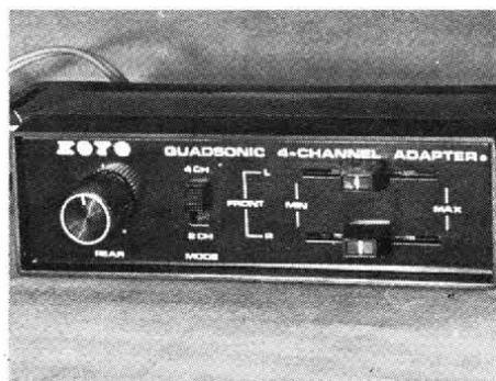
Décodeur permettant l'extraction de signaux quadraphoniques codés en deux canaux (Electro-Voice).
