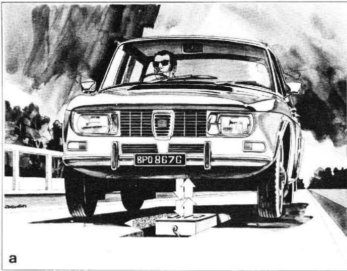
Fig. 7. — Tout véhicule passant au-dessus de ce coffret incorporé au revêtement de la route déclenche le dispositif de comptage...
