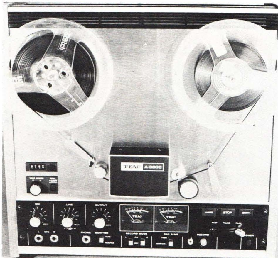
protecteur du bloc de têtes. Ce qui facilite grandement la mise en place de la bande, puisqu'il suffit, après l'avoir fait passer devant les têtes, de l'insérer, sans autre forme de procès, entre le cabestan et le galet presseur.
