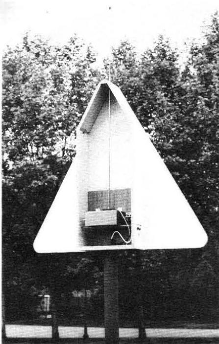
Fig. 2. — Le panneau signalant un carrefour dangereux équipé d'un mini-émetteur avertisseur (R.T.C.).
