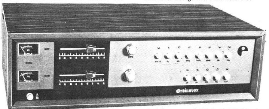
de fréquences de 20 à 12 000 Hz. La distorsion par harmoniques de tels appareils est très faible, de l'ordre de 0,3 %.
