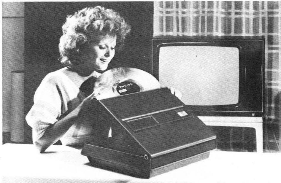
**Le vidéo-disque VLP se présente sous l'aspect d'un classique microsillon 33 tr/mn. Sa surface est rendue réfléchissante grâce à une métallisation sous vide.**
