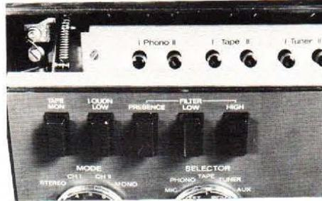
Les réglages de niveau des différentes entrées sont accessibles, de l'avant, derrière un volet escamotable.
