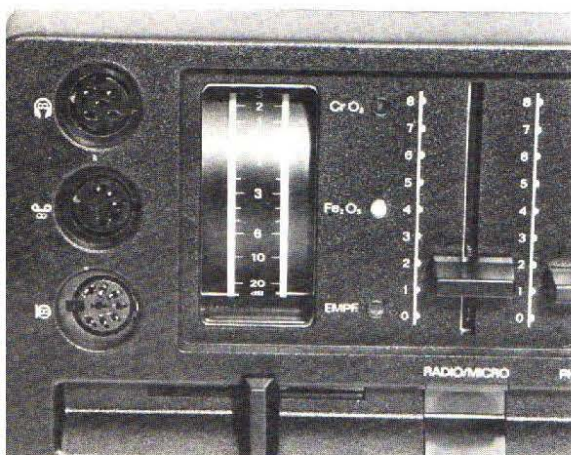
Un double Vu-mètre, indicateur de crête, permet les réglages de niveau. Une série de prises externes est disponible pour le casque, un magnétophone extérieur et le micro. La sélection du type de bande est automatique et signalée à l'aide d'un voyant.
