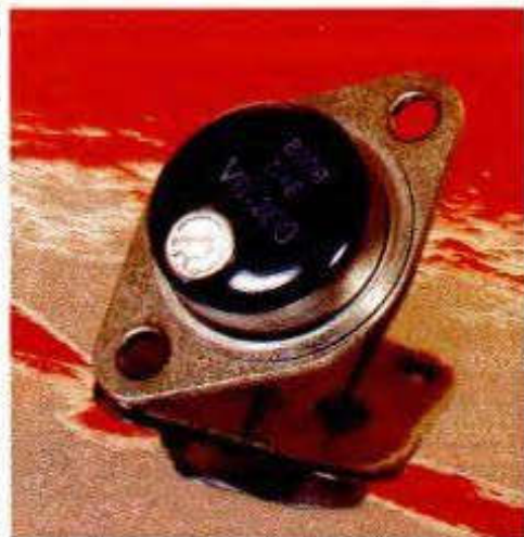
On aperçoit nettement l'ajustable intégré au boîtier.
