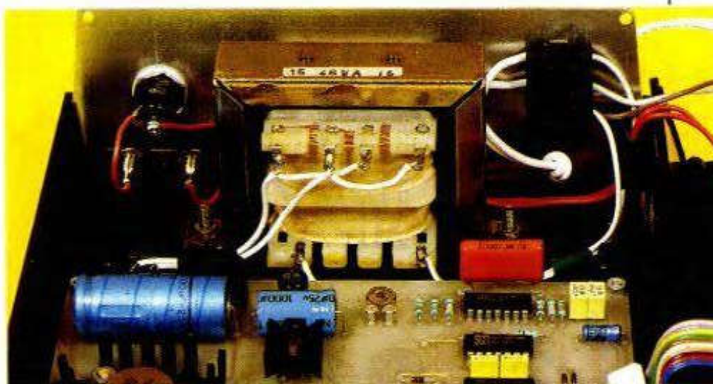
Photo 5. - Position du transformateur à l'intérieur du coffret Teko.
