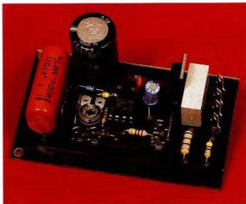
Photo 2. - On aperçoit le condensateur de la section d'alimentation.
