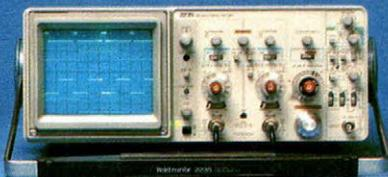
Oui : 16000F. Encore plus précis et plus rapide, le 2235 établit un nouveau record performances/prix. Amplificateur haute qualité, tube cathodique très lumineux, double base de temps alternée et visualisation du signal de déclenchement... Un oscilloscope performant ultra-léger (6,1 kg) et économique.
