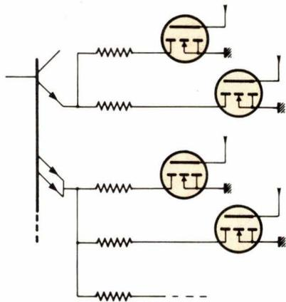
Fig. 8. — Commandes multiples sur un même accès d'émetteurs.
