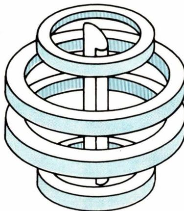
Fig. 17. — Aimant « corps entier » constitué par des bobines à air (d'après J. Chambron et Coll.).
