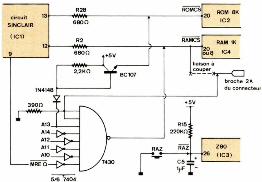
Fig. 2. — Schéma de principe de l'adaptation.
