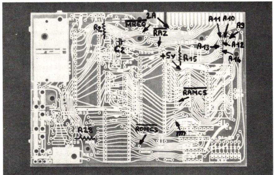
Repérage des branchements à effectuer sur le circuit imprimé après coupure des deux pistes mentionnées dans le texte.
