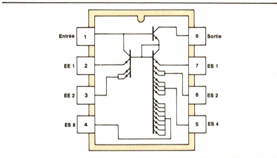
Fig. 1. - Avec trois émetteurs dans son circuit d'entrée et quinze dans son circuit de sortie, le miroir de courant TL 010 peut être programmé sur trente-trois rapports différents d'intensité.
