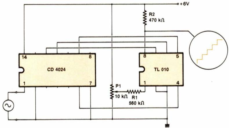
Fig. 2. - Tant qu'on travaille à faible niveau, on peut commander les accès de programmation du TL 010 directement par un circuit MOS.
