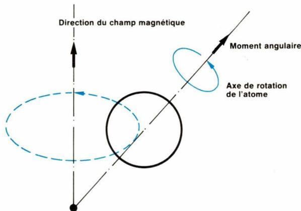
Fig. 5. - Mouvement d'oscillation d'un atome placé dans un champ magnétique.
