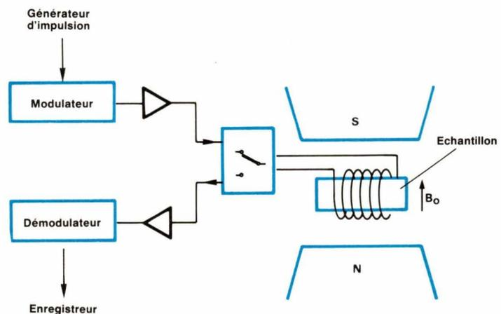
Fig. 11. — Schéma de principe d'un spectromètre RMN.
