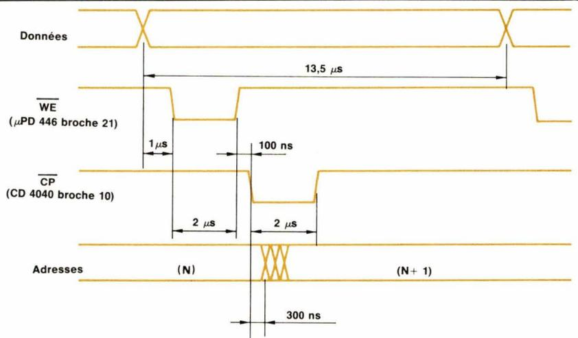
Fig. 5. – Chronogrammes relevés lors du chargement de la mémoire, à l'aide du dispositif préconisé (l'horloge du Z80 est à 2 MHz).
