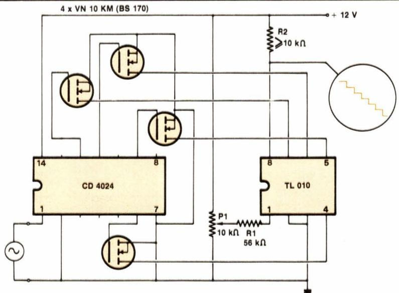
Fig. 3. - Une commutation par transistors V.MOS permet une meilleure linéarité et un niveau de sortie plus élevé. La hauteur des quinze marches peut être ajustée par  $P_1$ .
