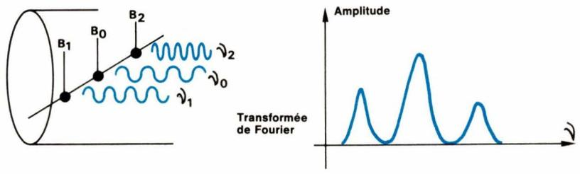
Fig. 15. - Dans le codage par dispersion, chaque volume élémentaire possède une fréquence de résonance qui dépend de sa position à l'intérieur du volume de l'objet. L'analyse par transformée de Fourier, permet d'obtenir le spectre de fréquence de l'objet (d'après Vincensini).
