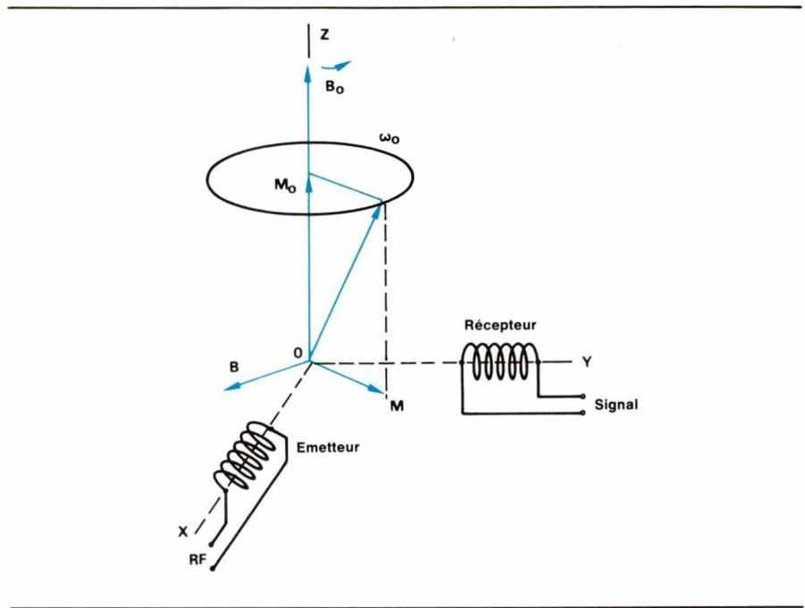
Fig. 10. — Action du champ tournant B sur le moment magnétique.
