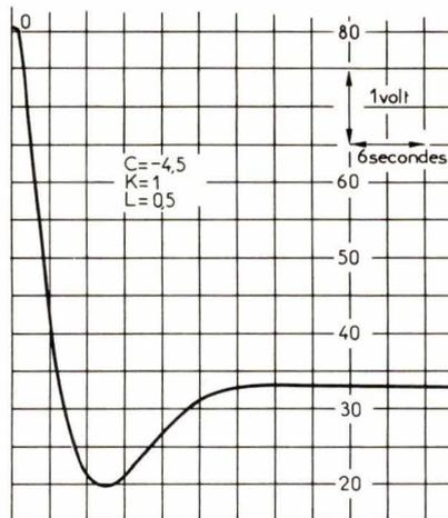
Fig. 9. - Réponse à un échelon (sortie du processus).
