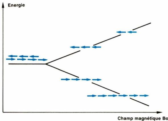
Fig. 8bis. - Dans un champ magnétique  $B_0$ , les moments magnétiques associés aux nucléons s'orientent, vis-à-vis du champ  $B_0$ , d'une manière parallèle ou anti-parallèle. Les deux orientations possèdent des énergies différentes et les transitions entre les niveaux d'énergie peuvent être induites par le champ magnétique d'une oscillation radiofréquence à la fréquence de Larmor. (Résonance)
