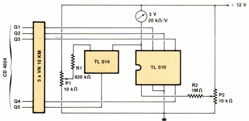
Fig. 6. - Conversion binaire-décimal 5 bits avec « affichage » par un contrôleur universel.
