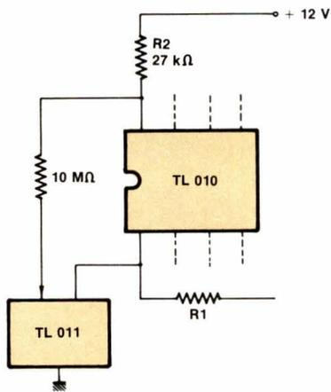
Fig. 5. - Correction de linéarité par réaction positive.
