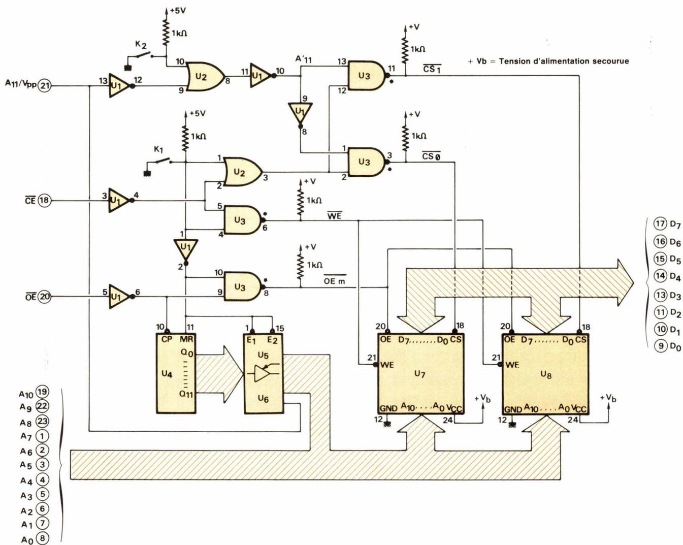
Fig. 1. - Schéma logique du simulateur. les numéros circlés sont ceux du socle 24 broches correspondant aux numéros 2716 et 2732. Circuits intégrés : U<sub>1</sub> = 74LS04 ; U<sub>2</sub> = 74LS32 ; U<sub>3</sub> = 74LS38 ; U<sub>4</sub> = CD4040 ; U<sub>5</sub>-U<sub>6</sub> = 74LS365 ou 367 ; U<sub>7</sub>-U<sub>8</sub> =  $\mu$ PD446-2.
