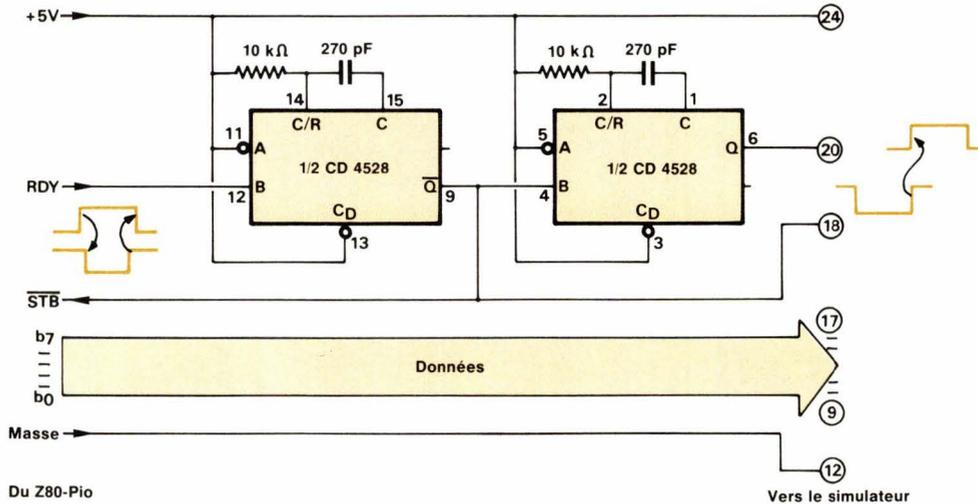
Fig. 4. – Dispositif de chargement du simulateur par un port de sortie du micro-ordinateur utilisant un double monostable CD4528.
