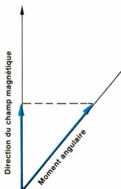
Fig. 6. - Le moment angulaire se projette sur la direction du champ magnétique en donnant des longueurs variables, en fonction de l'angle d'inclinaison.
