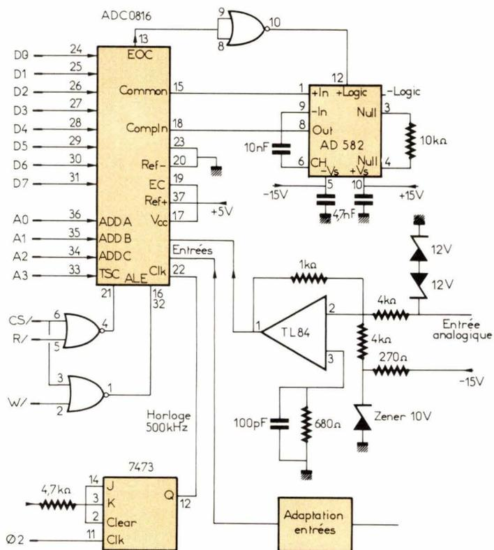
Fig. 7. - Carte convertisseur analogique/digital (16 voies, 8 bits).
