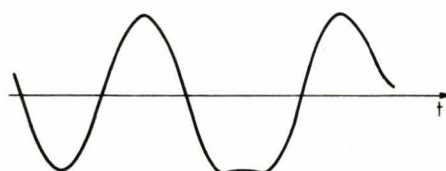
Fig. 5. — Suite (1)-1-0-(0) en modulation biphase.
