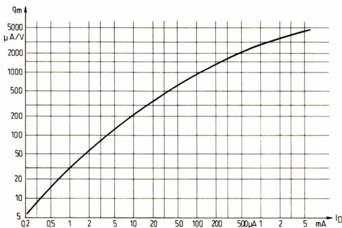
Fig. 9. — Relation entre transconductance g_m et intensité de drain I_D dans le cas d'un transistor à effet de champ de type courant (2N3819).
