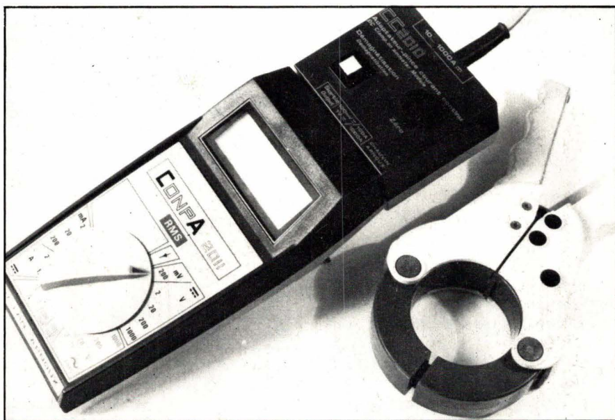
Le CONPA 2011 muni de sa pince ampèremétrique à effet Hall.
