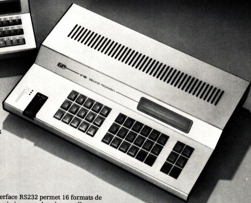
L'interface RS232 permet 16 formats de transmission avec des vitesses allant jusqu'à 19200 bauds. La possibilité de programmer des micro-ordinateurs mono-composants de type INTEL et NEC, jusqu'à 512 KO. de mémoire et ceci pour un prix de 12 500 F.
