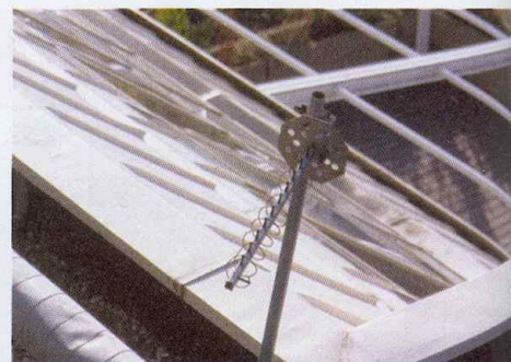
Une antenne hélicoïdale professionnelle, pour liaison "point à point"
