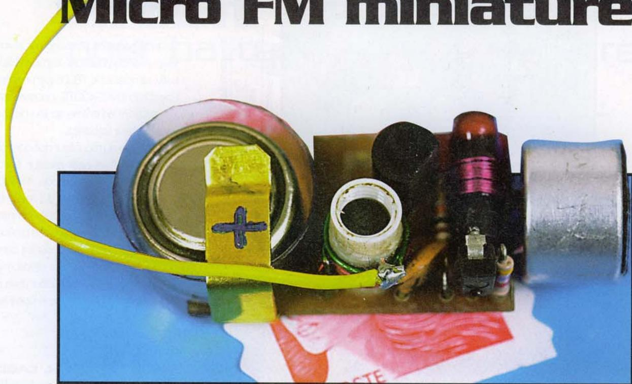
Ce petit émetteur autonome pour la bande FM, d'une portée d'une trentaine de mètres en extérieur malgré sa puissance réduite, est destiné à la surveillance du bébé, au micro HF, à l'expérimentation, etc. Afin de privilégier la simplicité et la miniaturisation, tout en restant dans des limites raisonnables, nous avons décidé de réaliser un système autonome, alimenté par une pile bouton de 1,5V, tout en incluant le microphone.
