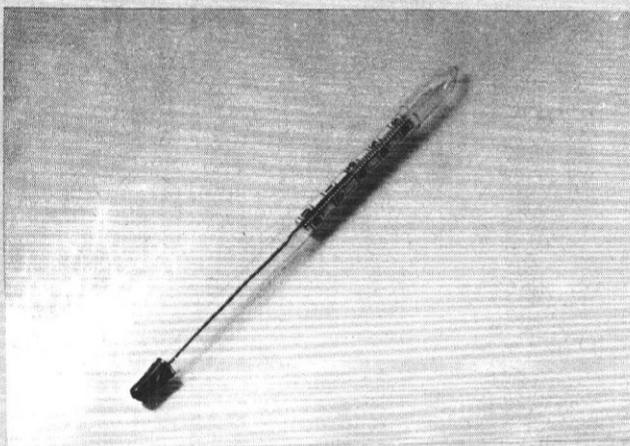
Un petit thermomètre à alcool, flottant, constitue le type de thermomètre le plus utile à avoir dans un laboratoire photo. La colonne teintée en bleu généralement, est visible, même à la lumière inactinique, et peut donc être utilisée, également, flottant sur la cuvette pour les tirages papier.
