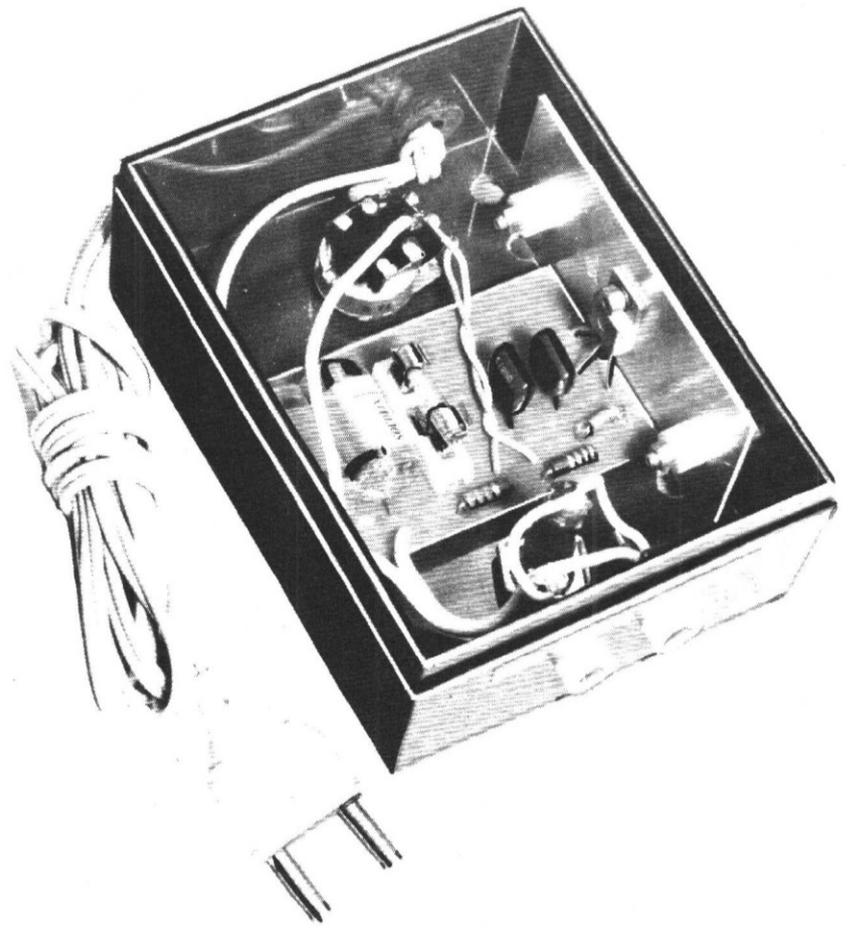
La variation d'intensité lumineuse d'une lampe ou d'une installation d'éclairage n'a pu être obtenue pendant longtemps qu'à l'aide de systèmes à rhéostat qui n'étaient pas sans présenter de gros défauts. Nous citerons simplement : le manque de souplesse et la perte d'énergie électrique par effet Joule.
