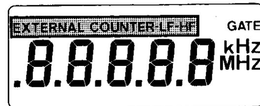
Dans ce mode, des symboles spécifiques (en grisé sur la vue du LCD) sont utilisés, en plus des symboles : .8.8.8.8.8, GATE, kHz, MHz décrits au paragraphe 3-2-1 (Générateur de fonctions).
