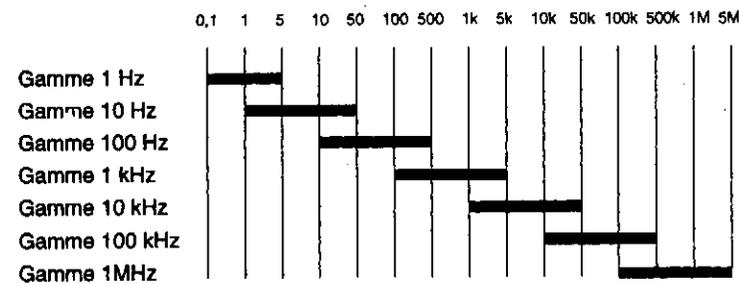
Exemple : La fréquence 400 Hz peut s'afficher 400,00 Hz sur la gamme 100 Hz ou 400,00 Hz sur la gamme 1 kHz.
