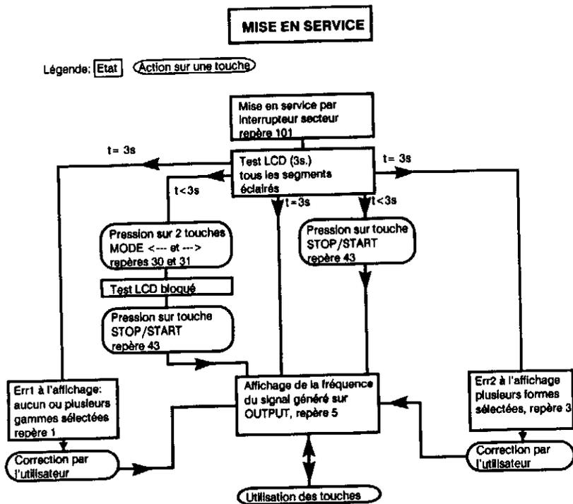
Pour passer du mode générateur au mode fréquencesmètre, utiliser une des touches MODE <---> (repères 30 et 31); voir le schéma des repères 30 et 31.
