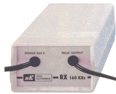
Figure 3 : Photo d'un des prototypes du récepteur de la télécommande à courant porteur EN1502. A l'intérieur deux circuits imprimés : la platine de base EN1502 et la petite platine à relais EN1502B.
