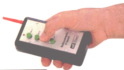
Figure 2 : Photo d'un des prototypes du récepteur de la radiocommande à 433 MHz surpuissante EN1475.
