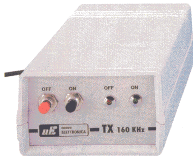
Figure 2 : Photo d'un des prototypes de l'émetteur de la télécommande à courant porteur EN1501. La face avant comporte deux poussoirs OFF et ON et des LED de signalisation.
