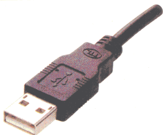
Figure 8 : Photo d'un connecteur USB de type A. Cette prise est normalement utilisée pour relier le PC aux différents périphériques.
