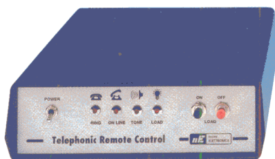
Figure 2 : Photo d'un des prototypes de la télécommande téléphonique EN1510 installée dans son boîtier et prête à être branchée à la ligne et au téléphone.
