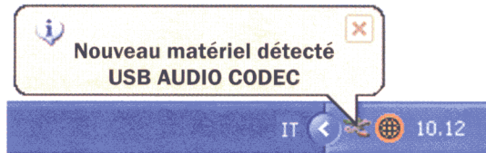
Figure 1 : Avant d'utiliser le programme Audacity, vous devez relier le convertisseur au PC par le port USB et à la source musicale choisie au moyen des entrées L et R. A l'écran apparaît (seulement à la première connexion) alors l'inscription ci-contre. Cliquez sur l'icône Audacity (voir figure 8 de l'encadré précédent) pour ouvrir le programme (voir figure suivante).
