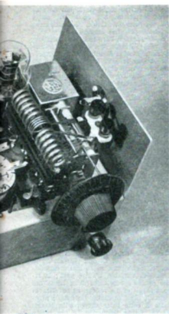
Plaque L<sub>1</sub> et L<sub>2</sub> avec l'enroulement antenne L<sub>3</sub>.
