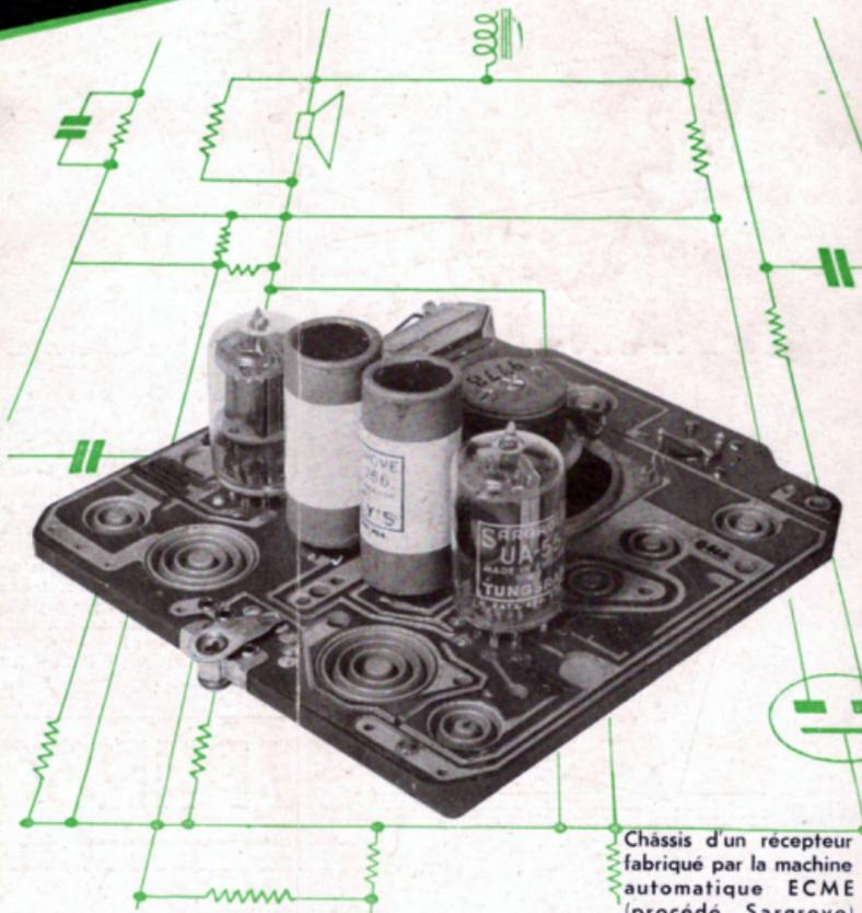
Châssis d'un récepteur fabriqué par la machine automatique ECME (procédé Sargrove)
