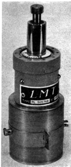
Onduiseur à cavité résonnante L.C.T. Gamme de mesure 10 à 15 cm. Précision 2,5. 10-4. Coefficient de surtension 5.000 à 10.000.
