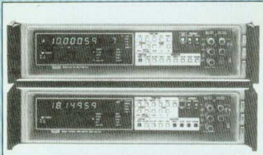
s'intégrer à un système contrôlé de mesures à vitesse de transfert rapide. Le 8505A est conçu autour d'un microprocesseur, donnant ainsi à l'utilisateur une
