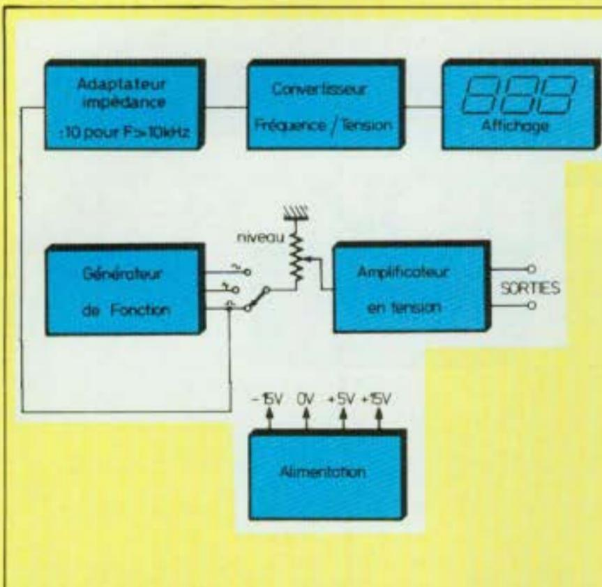
Fig. 1 : Synoptique du générateur de fonctions. Il délivre trois formes de signaux de 10 Hz à 50 kHz et la fréquence est affichée sur trois digits.
