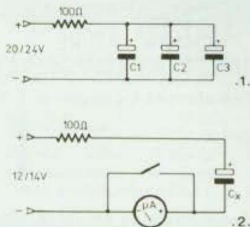
Fig. 4 : Préparation des condensateurs.
