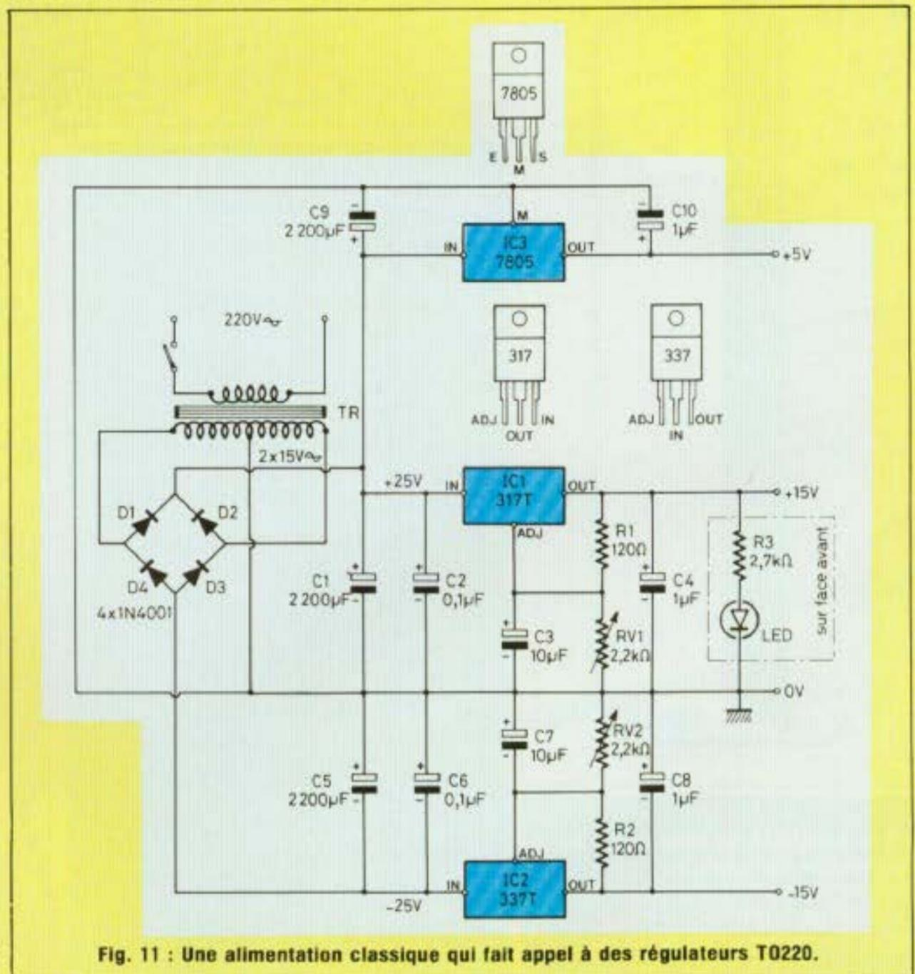
Fig. 11 : Une alimentation classique qui fait appel à des régulateurs TO220.
