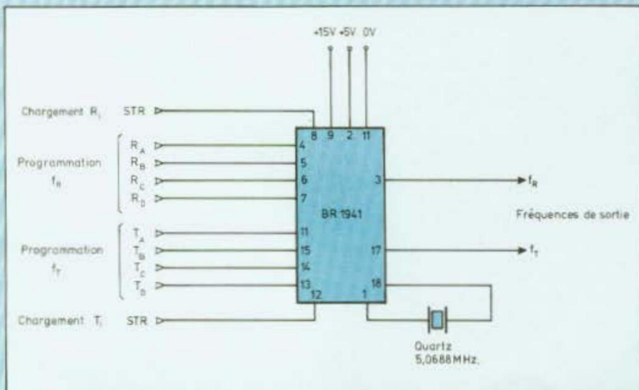
Fig. 1 : Générateur d'horloge à base de BR1941.
