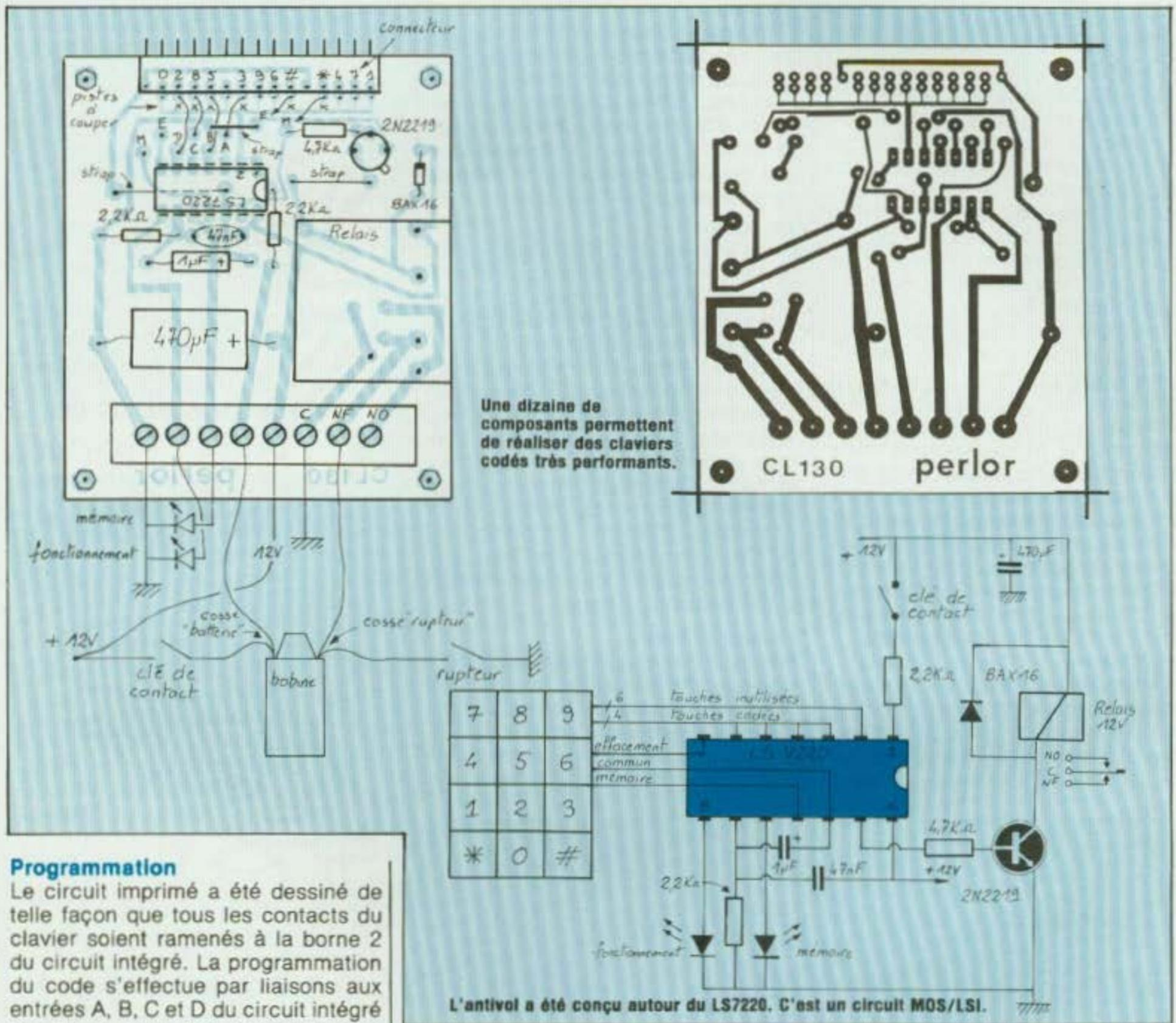
Une dizaine de composants permettent de réaliser des claviers codés très performants.
