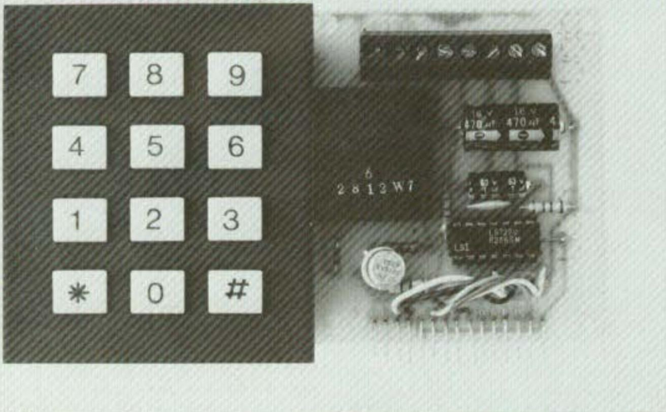
Réaliser un montage de principe complexe mais très simple, c'est ce que permettent les circuits intégrés modernes. Les deux montages dont nous vous proposons la description en sont le parfait exemple. Une dizaine de composants actifs ou passifs permettent de réaliser des claviers codés très performants. L'un est un interrupteur à touches, monostable ou bistable, l'autre est plus spécialement destiné à l'antivol voiture.
