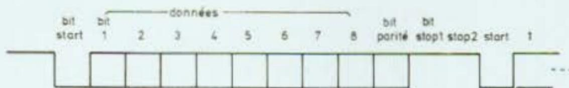
Fig. 3 : Format d'un transfert série.
