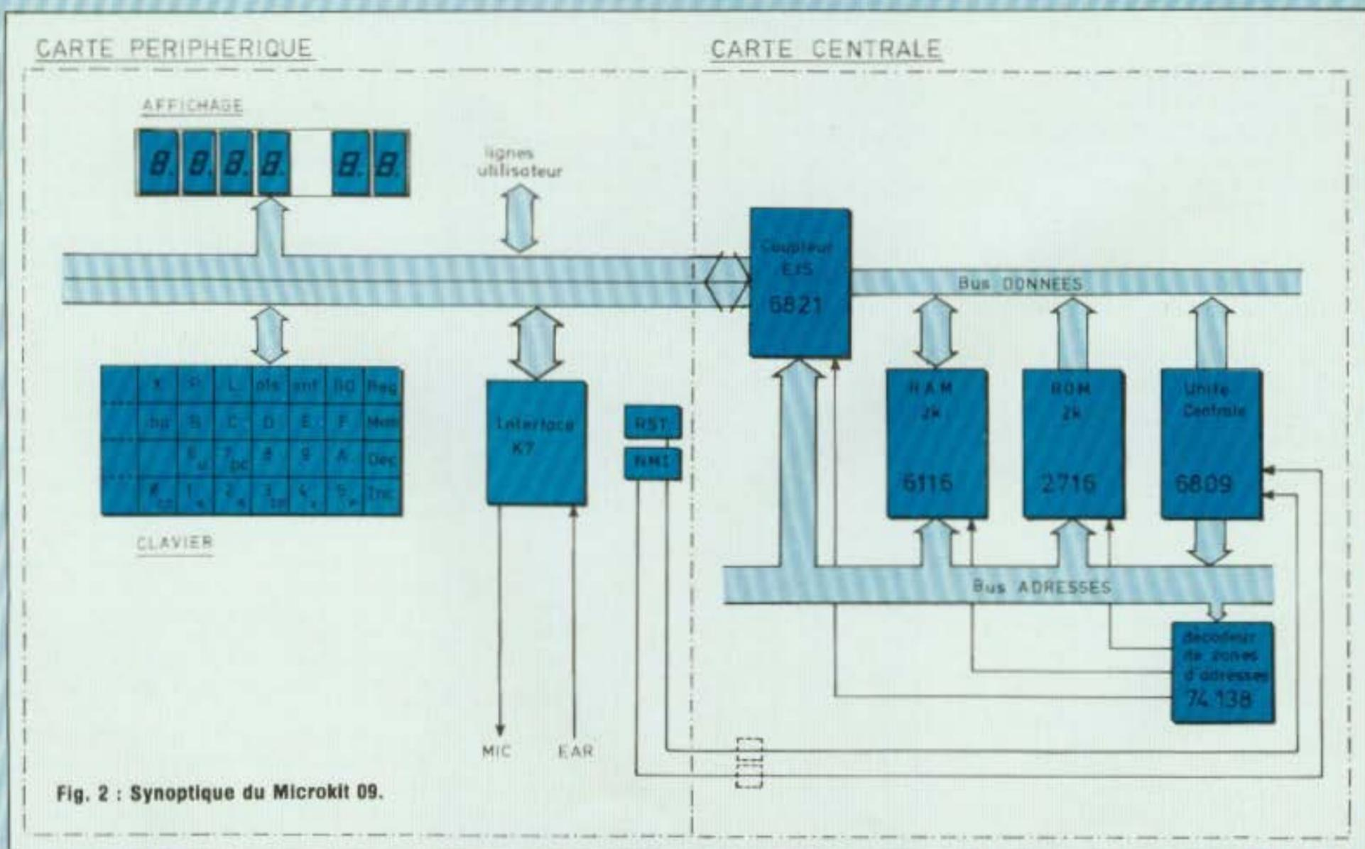
Fig. 2 : Synoptique du Microkit 09.
