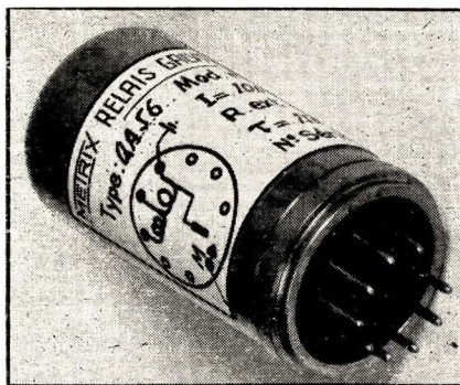
Aspect extérieur et schéma d'utilisation du relais galvanométrique.
