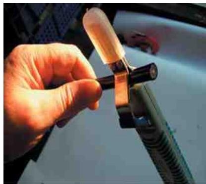
photo 2 : dénuder au moyen d'un couteau à dénuder
