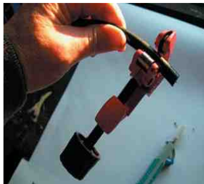
photo 3 : dénuder au moyen d'un petit coupe tuyau
