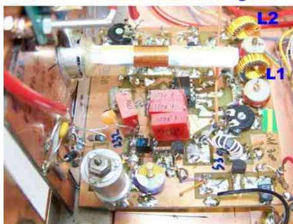
Photo 8 PTO / VFO mélangeur
