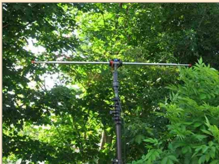
À noter que pour le J-POLE, l'espacement entre les deux fouets télescopiques est juste ce qu'il faut, soit : 3 pouces = 7.62 centimètres.
