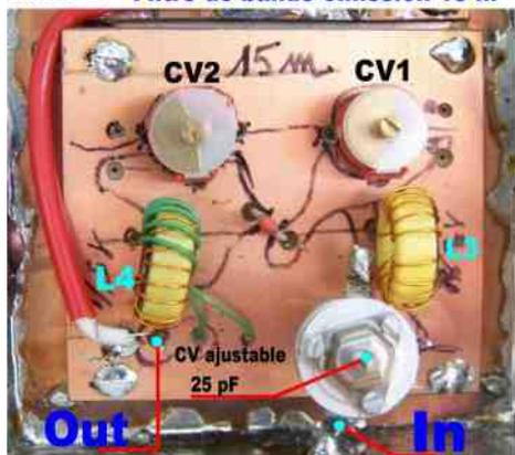
Le filtre de bande émission n'est plus intégré à l'étage Driver, il préserve la possibilité d'être utilisé en multi-bandes, commutation par diodes. Pour s'adapter au mieux au mélangeur NE612 son entrée est en haute impédance. La sortie reste classique en basse impédance 50 ohms.
