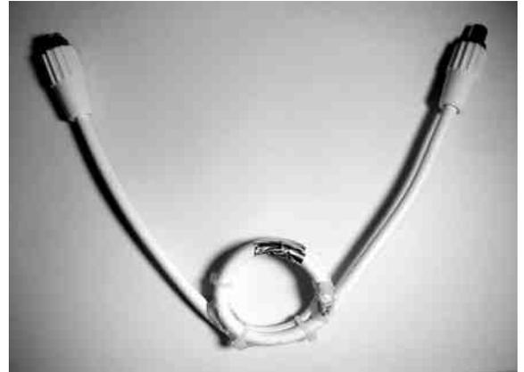
Au cours de l'été, les orages et les effets de la foudre provoquent des dégâts importants aux téléviseurs et souvent irrémédiables aux installations de d'antenne. Le présent dispositif apporte une protection supplémentaire contre les courants de gaine qui circulent sur le câble d'antenne. Ces courants s'écoulent généralement entre l'antenne et la masse châssis du téléviseur. En effet, le téléviseur réalise la jonction entre deux réseaux différents :
