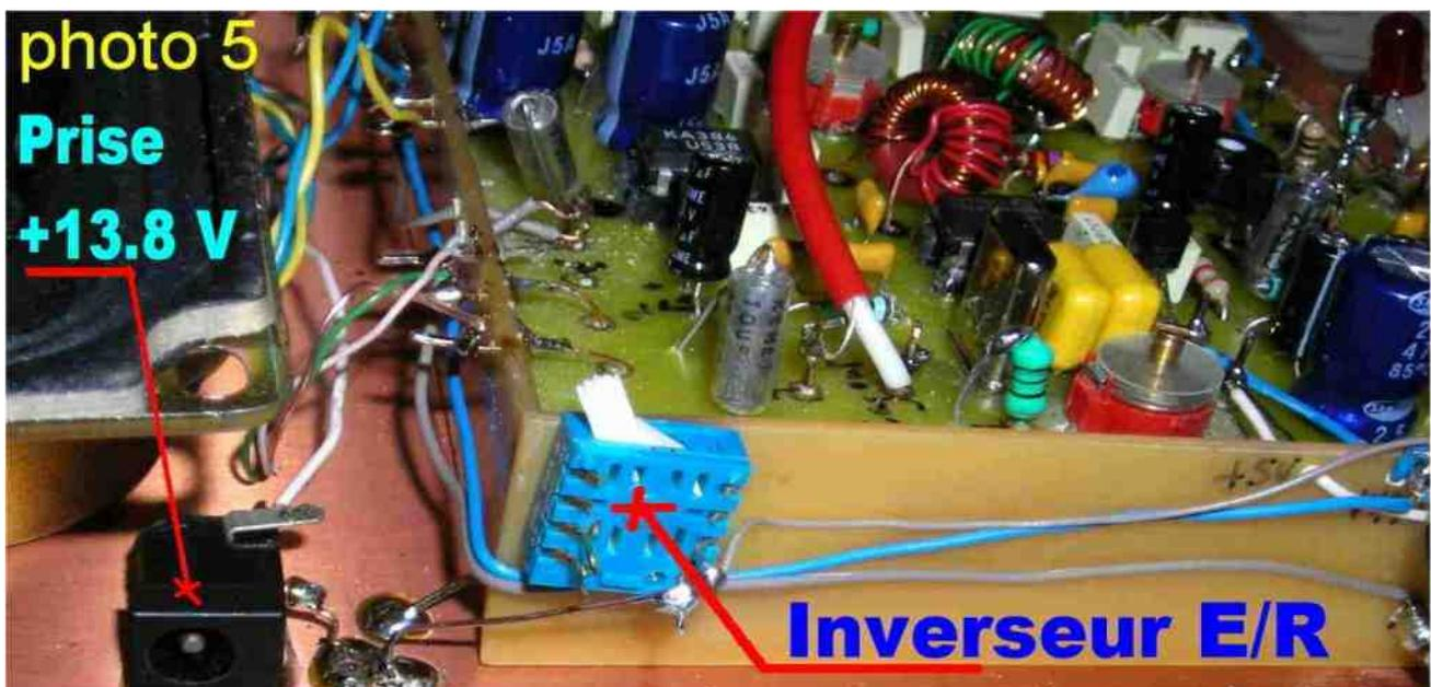
Sur la photo 5 la prise 13.8 V sert à l'alimentation générale du transceiver. Un simple inverseur à la place du PTT (interrupteur) commande l'Émission ou la Réception
