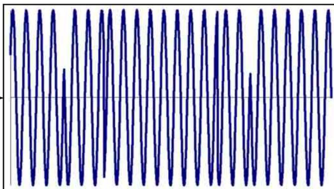
Les points d'inversion de phase sont repérés par les fleches. Il est évident que injecter un tel signal dans un émetteur va générer des fronts raides donc énormément de clicks !!
