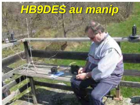
Légèrement différent (HI !) notre équipement se composait d'un Ft-817 puissance 5 watts d'une batterie 12vV/5Ah, d'une antenne verticale portable MP-1 multibandes et d'un manipulateur.
