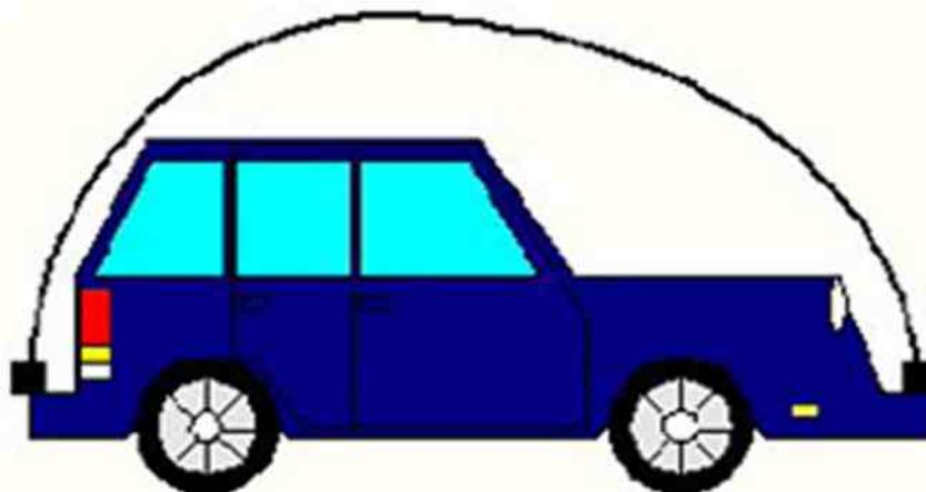
N.B. : Contrairement aux Britanniques, les militaires Américains déploient leur antenne en forme d'arc vers l'arrière du véhicule à l'aide d'un fil tendeur évitant ainsi l'absorption par le châssis. Malheureusement, notre code de la sécurité routière et le gros bon-sens nous interdisent de telles extravagances. Le compromis Britannique est de l'ordre de seulement quelques décibels de toute façon.
