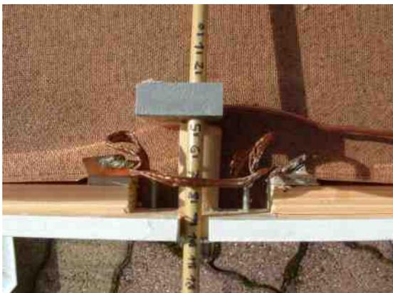
L'attaque se fait par un gamma match (voir schéma) en gros fil de cuivre .
