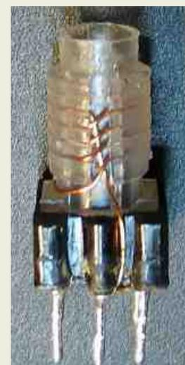
L'étage d'entrée nécessite un réalignement de T01 et T02 au générateur HF à 145 MHz : se baser sur le maximum de déviation du S-mètre.
