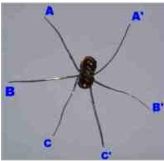
Photographies du détail de la confection du transformateur trifilaire. La partie marquée en l'air est repliée légèrement sans aucune incidence sur le fonctionnement et la puissance de sortie.
