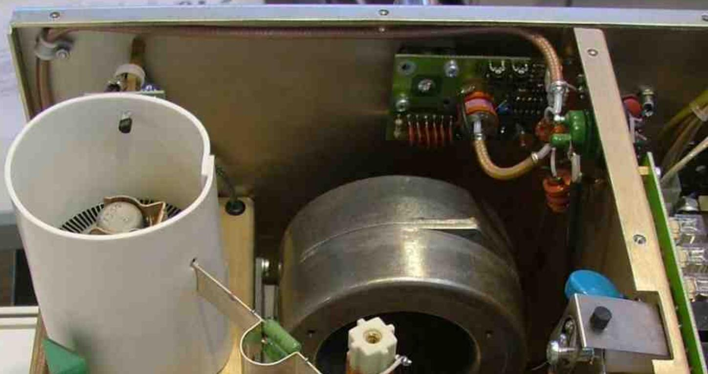
Etude et construction d'un appareil destiné au test, reconditionnement (régénération) et à l'apparentement (« matched pair of tubes ») des tubes électroniques de puissance (GU74B-4CX800A).
