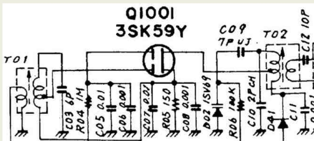
Pour dessouder T01 il est plus facile d'utiliser une panne large et un surplus de soudure pour chauffer les quatre broches en même temps, T01 doit venir sans résistance. Procéder de même pour Q1001, C03, et C07. Nettoyer les trous à la pompe à dessouder puis avec de la tresse très fine.
