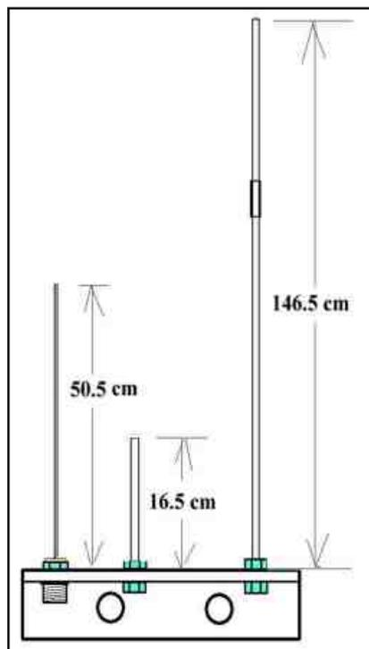
Les côtes sur le dessin de gauche, sont un peu plus grandes que sur le site de Arrowantennas, leurs antennes étant étudiées pour les fréquences 146/440 Mhz. L'augmentation de ces côtes permet de descendre la plage de fréquence pour une utilisation chez nous.
