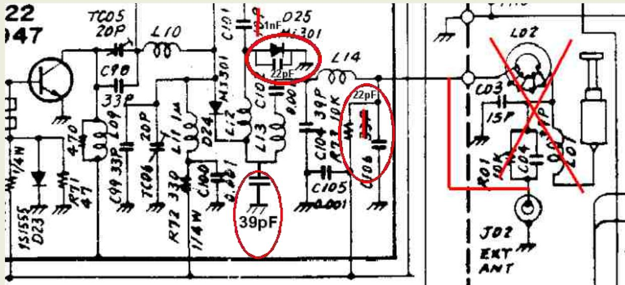
Du fait que le circuit imprimé soit en double face à trous métallisés il faut travailler avec un fer bien chaud muni d'une panne courte conique suffisamment « mouillée » d'étain. Les capacités céramiques peuvent être remplacées par des CMS 0805 ou 1206 COG 50 V soudées directement au revers du circuit imprimé.
