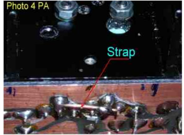
Les photos 4 et 5 détaillent l'utilisation d'un STRAP en fil de cuivre 5/10ème qui relie entre-eux les deux Drains des 2 x IRF510. Le STRAP est soudés directement sur les pistes ad hoc du circuit imprimé. En l'absence de STRAP le montage d'un seul IRF510 est possible pour une moindre puissance.
