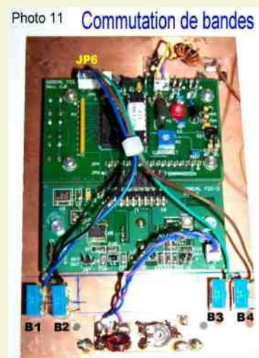
Face interne du DDS en fonction multi-bande et interrupteurs
