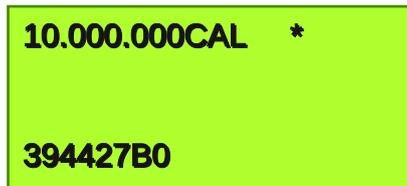
La calibration se fait sur 10 MHz et l'afficheur donne l'équivalent \*hexadécimal\* de la calibration de base D.D.S. : \* 394427B0\*
