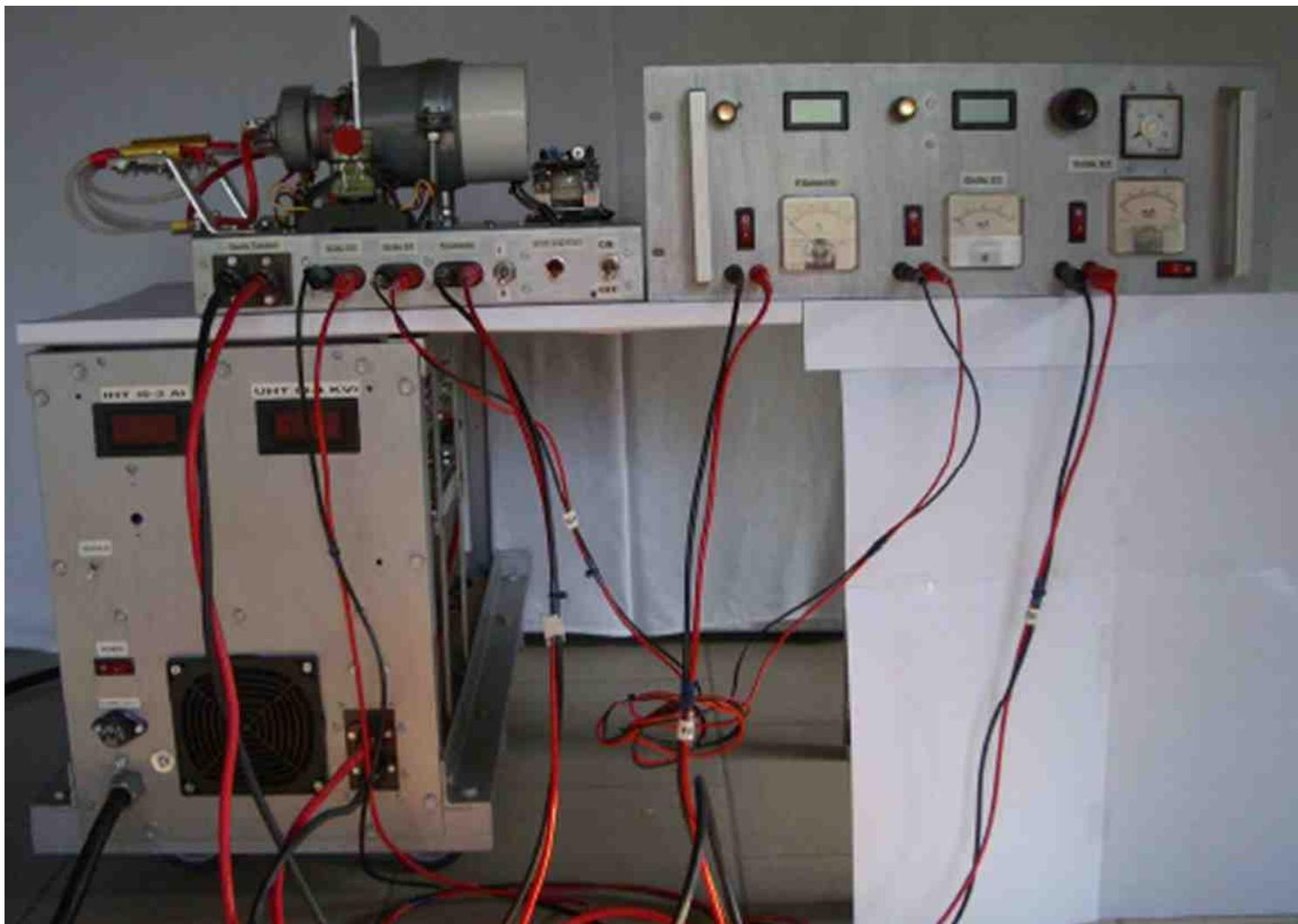
*Photo n° 2 : l'alimentation HT (4KV-2A).*
