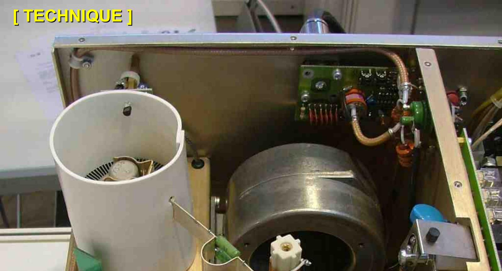
Etude et construction d'un appareil destiné au test, reconditionnement (régénération) et à l'appareusement (« matched pair of tubes ») des tubes électroniques de puissance (GU74B-4CX800A).
