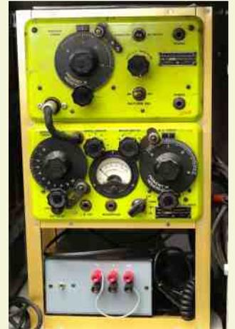
**WS-48:** émetteur-récepteur portable de 1942. Fabriqué aux Etats-Unis et utilisé durant la 2ème guerre par les anglais et les alliés en général. Couvre de 6 à 9 Mhz en AM et CW. Puissance de 250mW. Très joli objet de collection.
