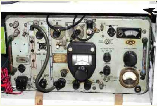
**WS-21:** émetteur-récepteur anglais couvrant de 4.2 à 7.5 Mhz et de 19 à 31 Mhz.
