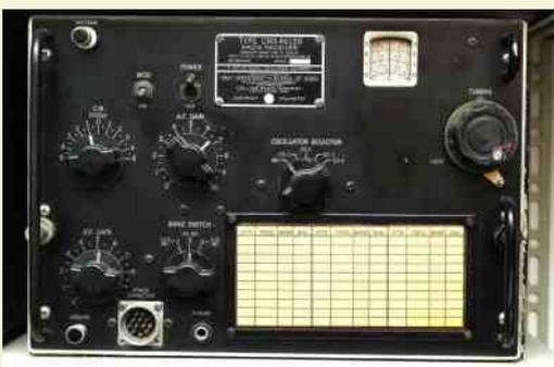
**TCS12:** ensemble émetteur et récepteur de l'US NAVY (env. 1940). Couvre de 1.5 à 12 Mhz, en 3 bandes. Fonctionne en AM et CW. Puissance de sortie de 25W en CW et de 10W en AM.
