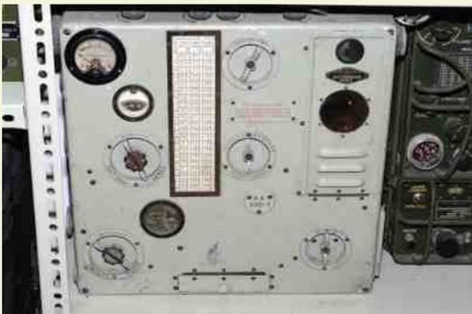
**RA350-1:** émetteur aéronautique italien des années 30. Couvre les bandes de 35 à 85m, 205 à 350m et 300 à 900m, en AM, MCW et CW. Utilise 3 tubes. Utilisés en tandem avec le récepteur AR5, à réaction.
