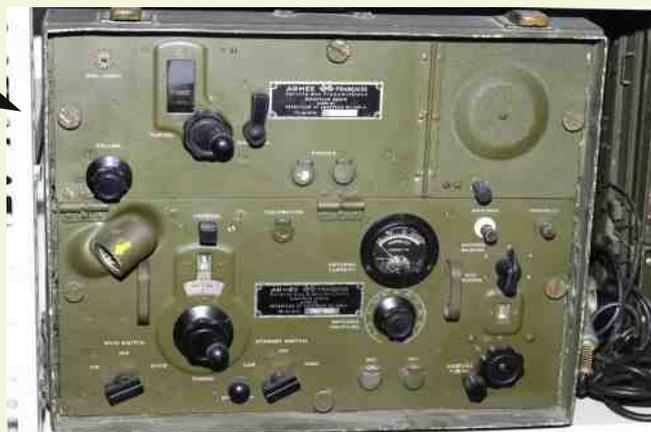
**Bendix TA12:** émetteur aéronautique de 40W, en AM, CW et MCW. Couvre 4 gammes de fréquences: 300 à 600KHz, 3 à 4.8 Mhz, 4 à 6.4MHz, et 4.37 à 7MHz. Le modulateur AM était séparé de l'émetteur.
