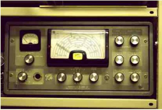
**G.222:** émetteur AM et CW Geloso, très célèbre. Fonctionne en AM et en CW. Utilise un tube 6146 au PA, modulé sur la plaque et l'écran. (Années 70).
