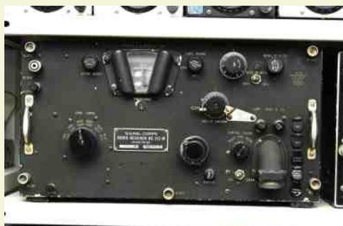
**BC-312**: récepteur très répandu. Conçu et produit à partir de 1941 et beaucoup utilisé par les radioamateurs à l'époque où les stations étaient de fabrication maison. Couvre de 1.5 à 18MHz en AM et CW.
