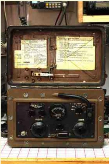
**WS-58:** émetteur-récepteur portable canadien développé durant la 2ème guerre(1943). Couvre de 6 à 9 Mhz en AM, avec une puissance de 300mW.
