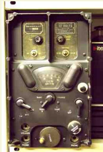
**BC-652:** récepteur de l'ensemble SCR506 (dont l'émetteur était le BC653). Couvre de 2 à 3.5MHz, et 3.5 à 6MHz en AM. Utilisé sur des véhicules durant la 2ème guerre mondiale.
