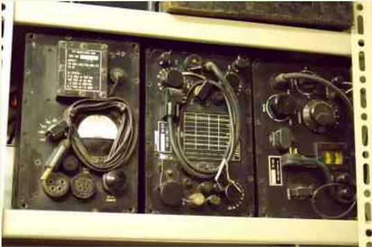
**GRC-109:** ensemble émetteur-récepteur-alimentation, utilisé par les forces spéciales US. Fabriqué à partir de 1961. Version militaire de l'ensemble RS1 des services secrets. Couvre de 3 à 24MHz en 3 bandes, en CW. Puissance de 10 à 15W.
