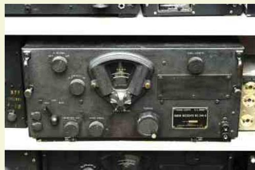
**BC-603/BC-683:** récepteurs FM identiques, mais couvrant deux gammes différentes: 20 à 29.7MHz pour le BC603, et 27 à 38.9MHz pour le BC683. Faisaient partie d'un ensemble comprenant l'émetteur BC604.
